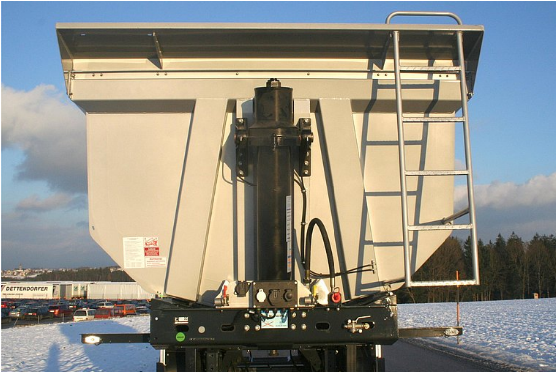
Schräge Vorderwand mit hartverchromtem, qualitativ hochwertigem Frontkippzylinder
