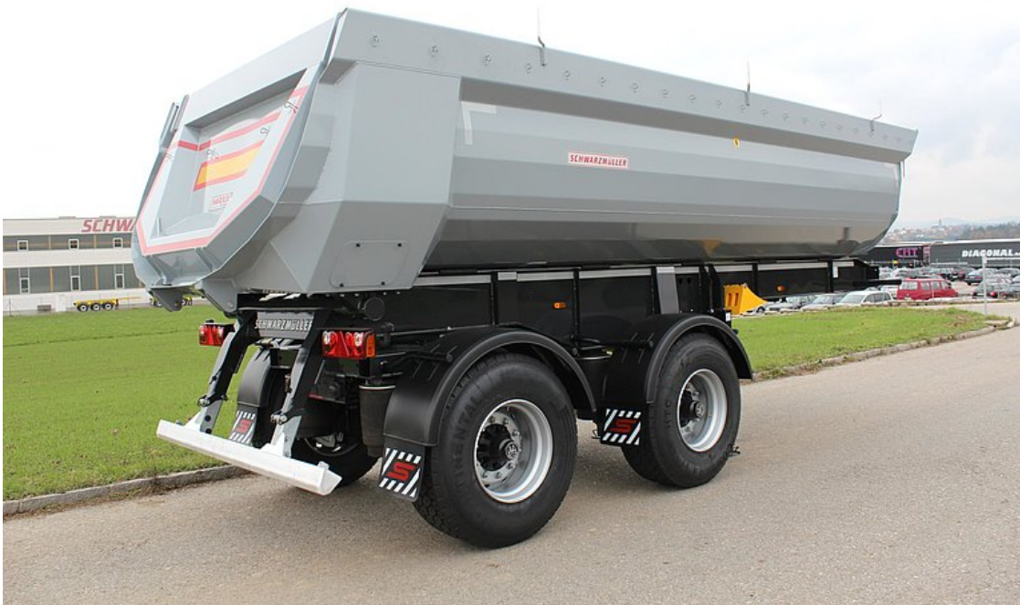
2-Achs-Stahl-Segmentmulden-Kippsattelanhänger - Radstand 1.810 mm
