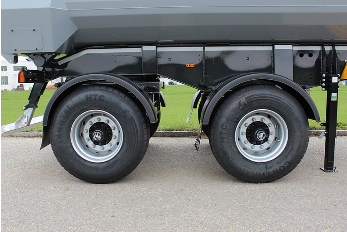
Achsen mit Radstand 1.810 mm
