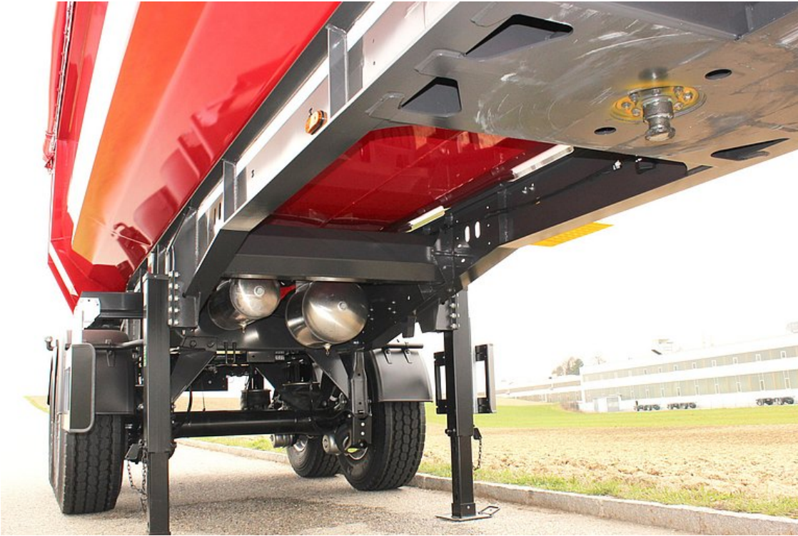
Stabile und verwindungssteife Fahrgestellkonstruktion mit zusätzlichen Torsionsrohren
