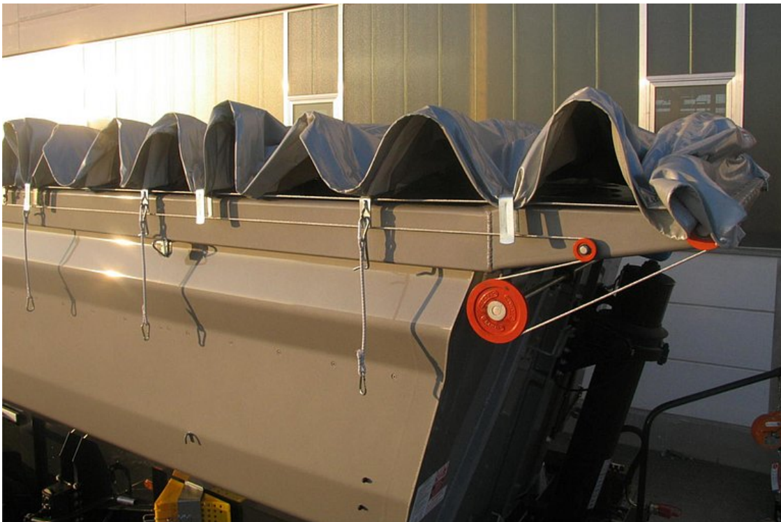
OPTIONAL: Rollverdeck - wahlweise manuell oder über elektrische Fernsteuerung bedienbar
