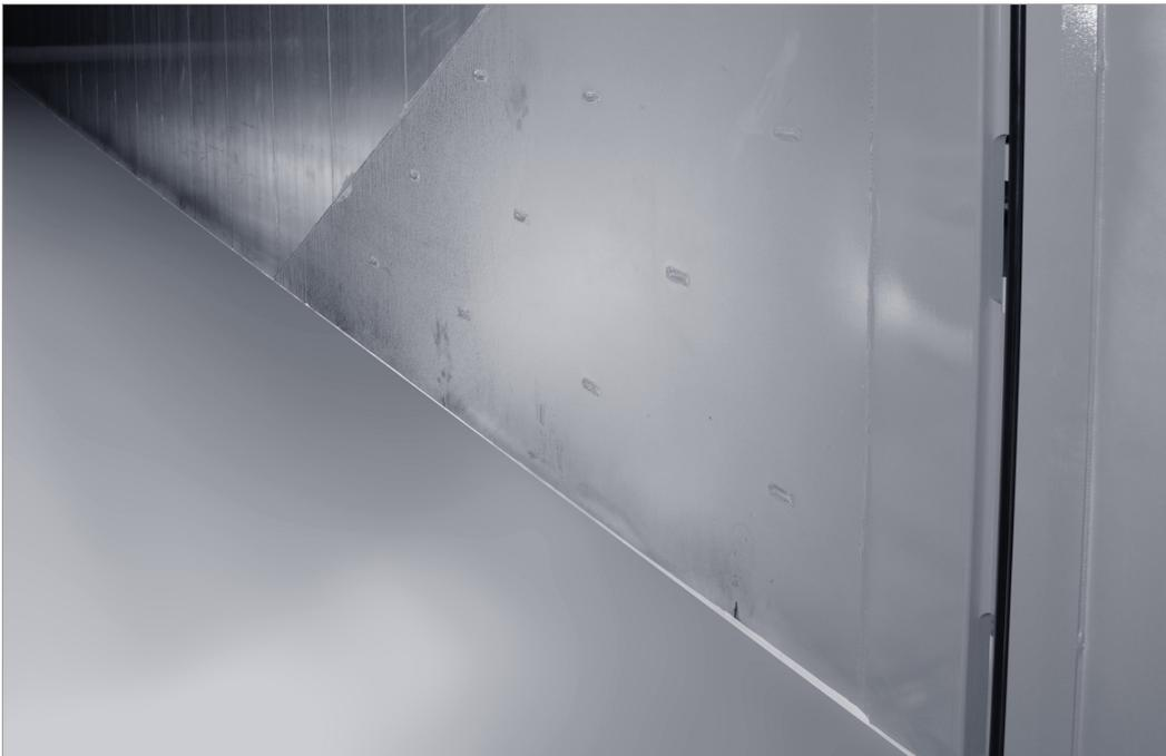
OPTIONAL: Aluminiumverschleißbleche - Beidseitige Verstärkungen im Heckbereich der Mulde schützen vor schnellem Verschleiß und erhöhen somit die Lebensdauer.
