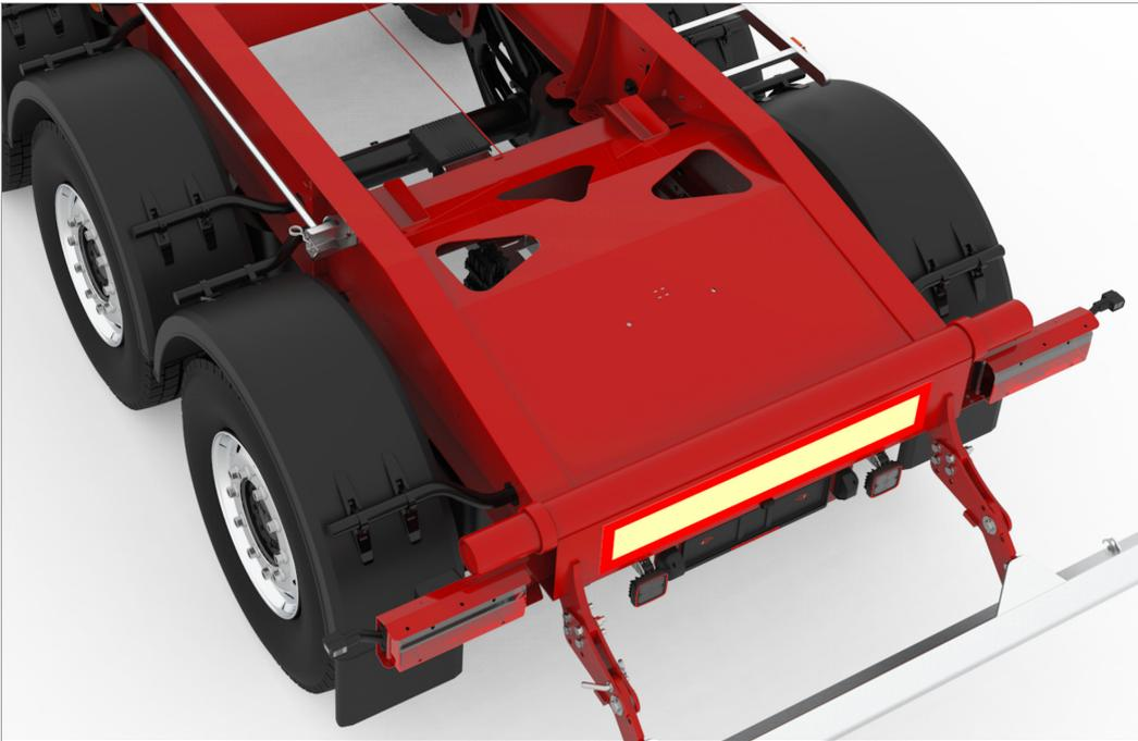
Torsionskasten: Eine bewährte und durchdachte Lösung, um im Heckbereich des Kippersattelfahrzeuges optimale Stabilität während des gesamten Kippvorgangs zu gewährleisten.
