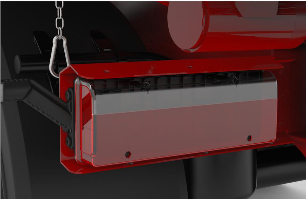
OPTIONAL: LED-Beleuchtung - Die Heckleuchte wird in der Standardversion als Teil-LED Leuchte ausgeführt. Optional auch als Voll-LED Leuchte möglich.
