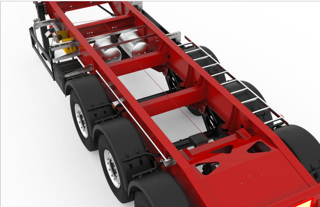
Torsionsrohre: Diese speziellen Querverbindungen sorgen ähnlich wie der Torsionskasten für zusätzliche Stabilität des Kippsattels während des gesamten Kippvorgangs.
