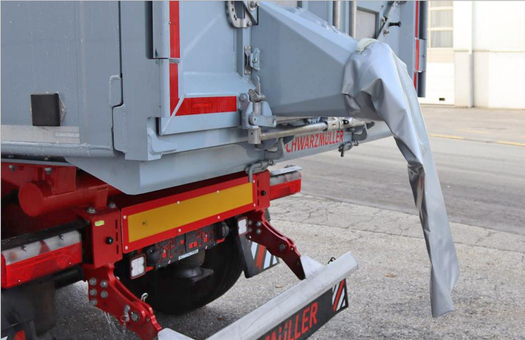
OPTIONAL: Staubsack - Der Staubsack ist ein einfaches Hilfsmittel zur Vermeidung einer Staubentwicklung.
