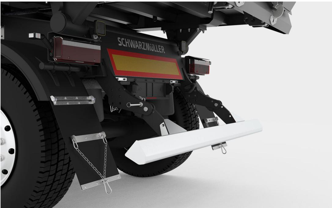
Der Unterfahrschutz wird standardmäßig hochklappbar ausgeführt, damit bei einer Fertigerbeschickung stets die nötige Bodenfreiheit gewährleistet ist.
