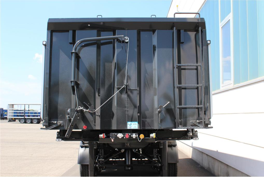
Fixe Stahlblech-Vorderwand mit Bindeösen, Aufstiegleiter und Haltebügeln
