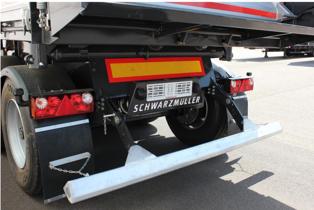
Klappbarer Unterfahrschutz für Fertigerinsatz
