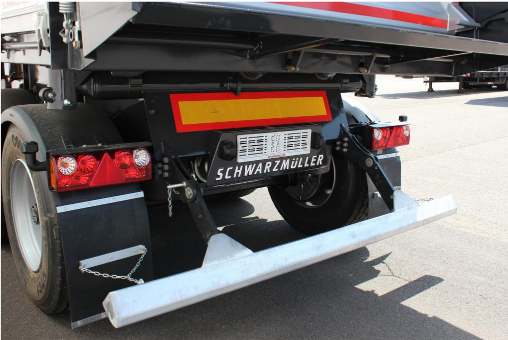
Klappbarer Unterfahrschutz für Fertiger Einsatz
