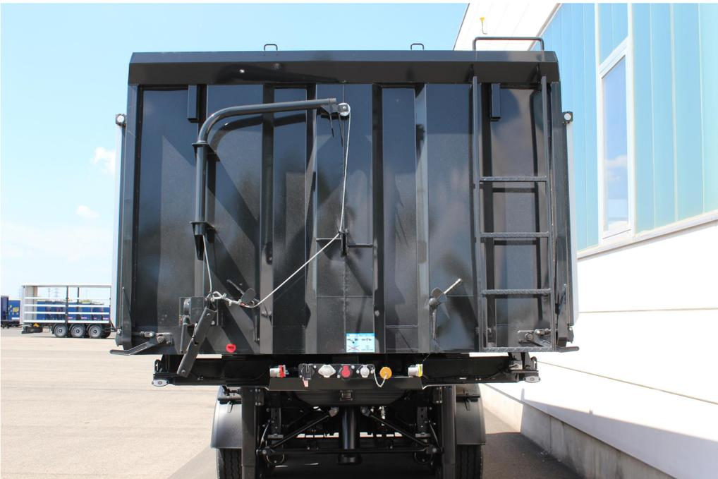
Fixe Stahlblech-Vorderwand mit Bindeösen, Aufstiegleiter und Haltebügeln
