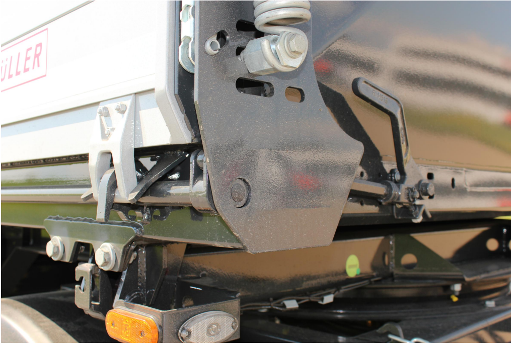
Manuelle Zentralverriegelung zum öffnen der Seitewände mit Hebel und Zentralverriegelungswelle
