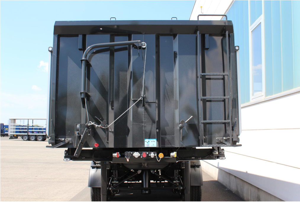
Fixe Stahlblech-Vorderwand mit Bindeösen, Aufstiegleiter und Haltebügel
