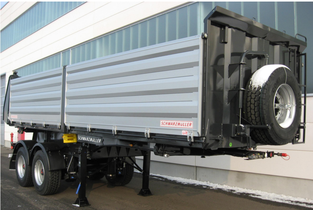
Fixe Stahlblech-Vorderwand mit Bindeösen, Aufstiegleiter und Haltebügel
