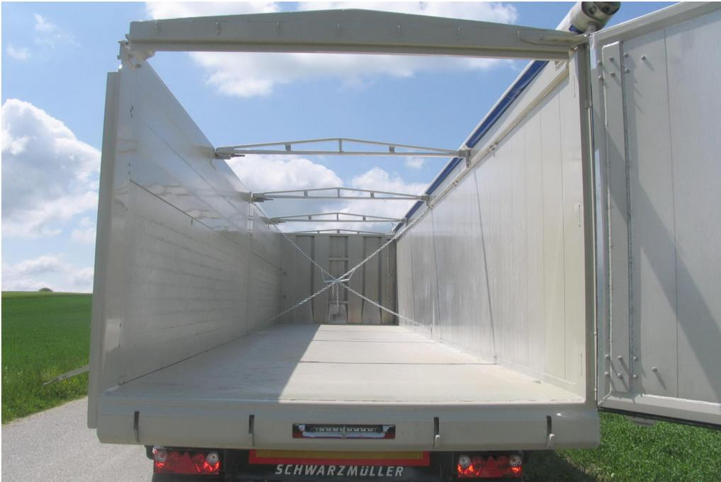
Hochwertige Aluminium-Mulde aus Hohlprofilen, für hohen Stoß- und Verschleißschutz
