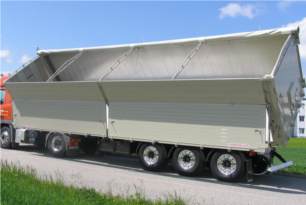
2-teilige Seitenwände inkl. abnehmbarer Mittelsäule für maximale Einladebreite
