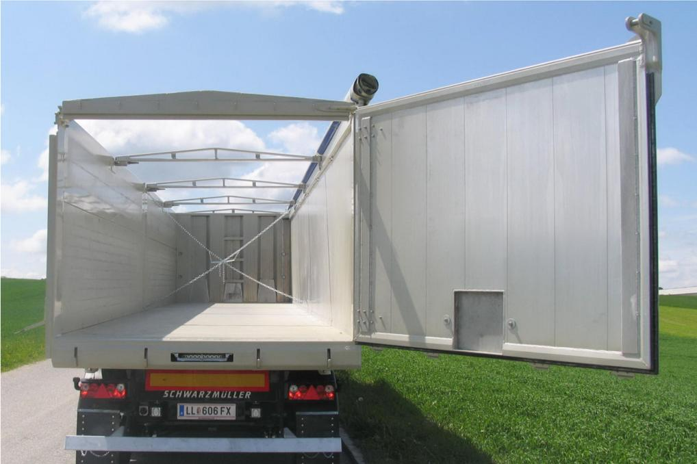
Kombinierte-Rückwand - 1-flügelige vollumschlagbare Türe und zusätzlich pendelbar mit autom.
