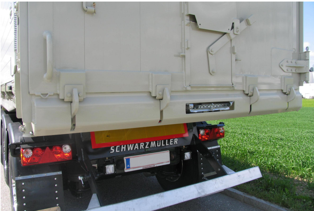
2-teilige Seitenwände inkl. abnehmbarer Mittelsäule für maximale Einladebreite
