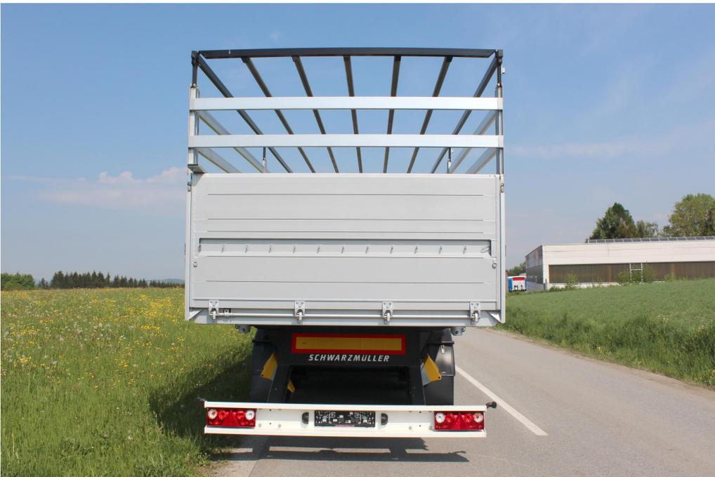
Aluminium-Hohlprofil-Rückwand, abklappbar mit verlängerte Schwenkriegelverschlüsse sowie zus. pendelbar mit man. Zentralverriegelung
