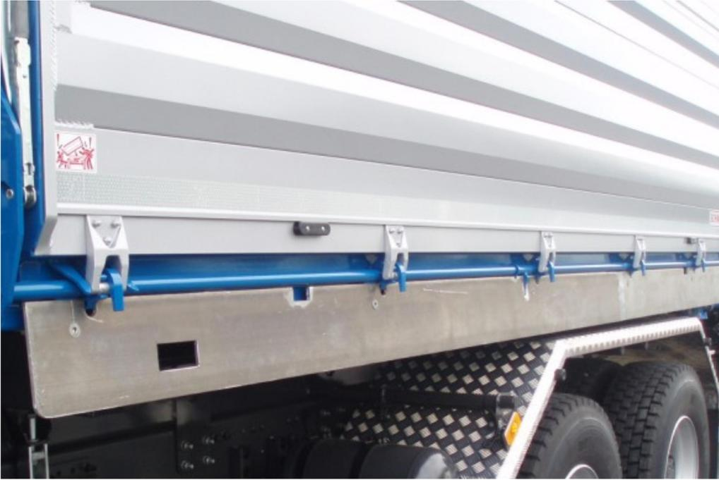
OPTIONAL: Aluminium-Klappe auf seitlicher Zentralverriegelungswelle
