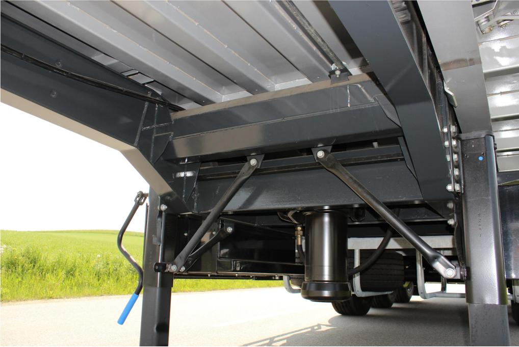
Stabiles und verwindungssteife Fahrgestellkonstruktion mit zusätzlichen Torsionsrohren für 3-Seiten-Kippung
