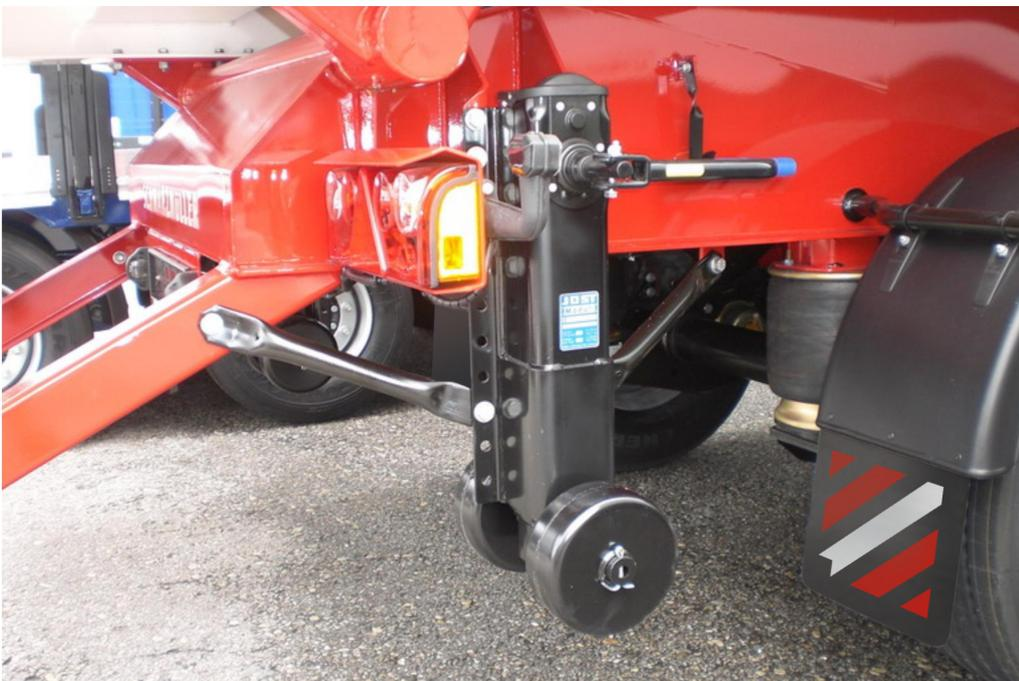
OPTIONAL: 2 mechanische Abstützwinden mit Rollen am Rahmenende
