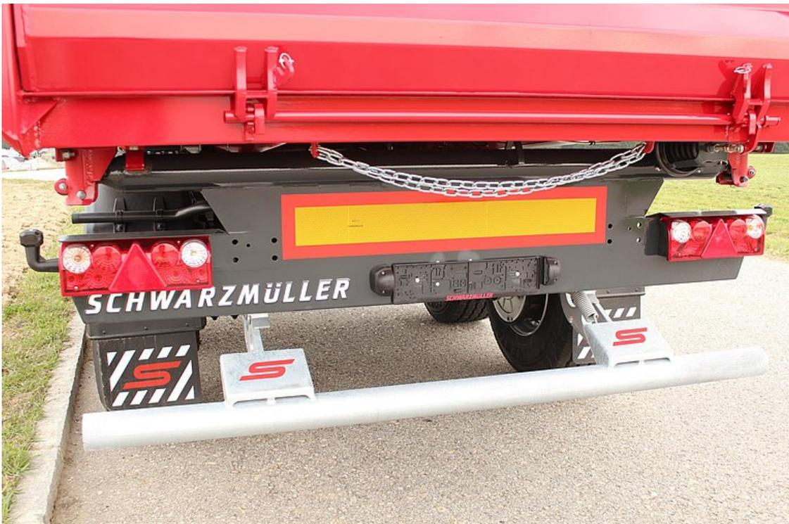
Rohr-Unterfahrschutz klappbar, mit Anfahrbock für Fertiger
