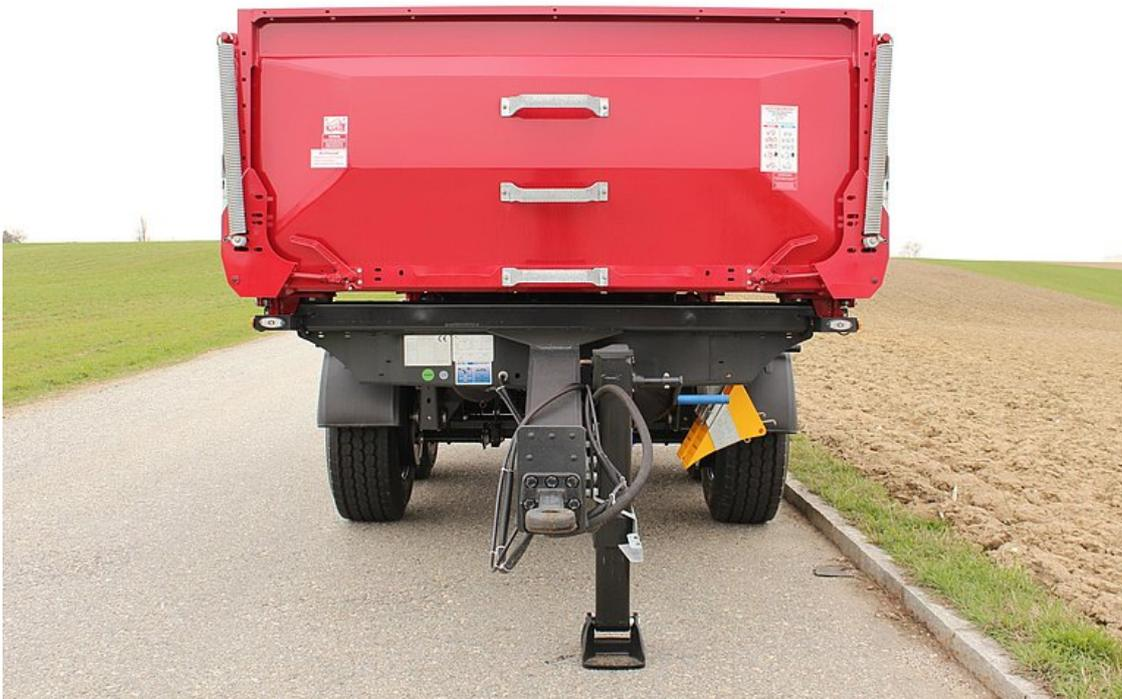
Stahlblech-Vorderwand mit Aufstiegsbügel außen und innen
