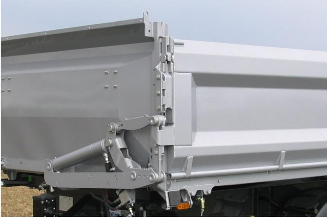
OPTIONAL: Linkseitig Bordmatic = hydraulisch abklappbare Seitenbordwand, mit doppelwirkendem Zylinder an der Vorderwand, vom Fahrerhaus zu betätigen
