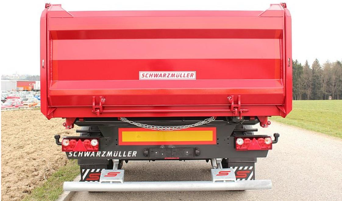
Stahlblech-Rückwand pendelbar, mit erhöhter Lagerung und autom. Pneumatikverschluss
