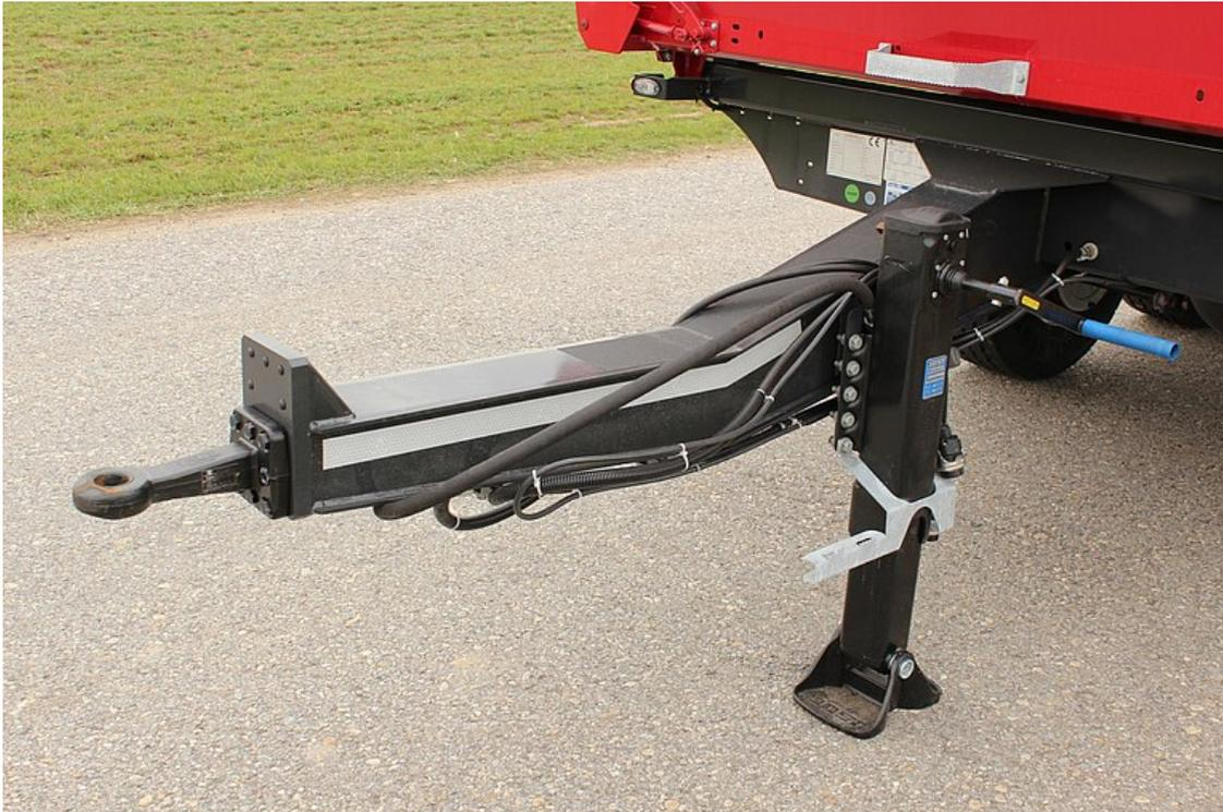
Zugstange gekröpft mit höhenverstellbarer Schraubzugöse inkl. 1 Aufstiegsbügel in Fahrtrichtung links
