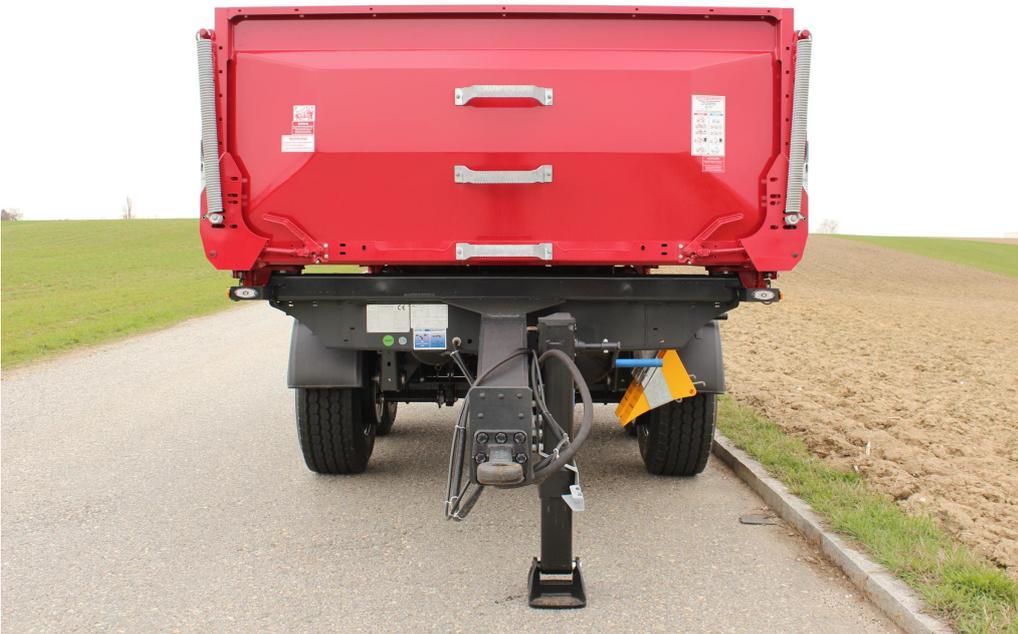
Stahlblech-Vorderwand mit Aufstiegsbügel außen und innen
