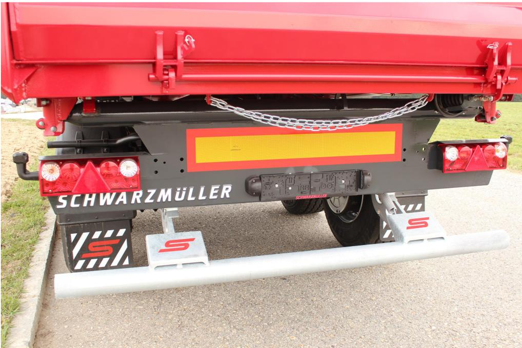
Rohr-Unterfahrschutz klappbar, mit Anfahrbock für Fertiger
