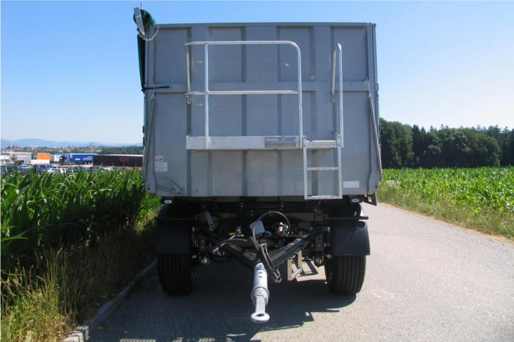
Vorderansicht - Fixe Stahlblech-Vorderwand & Zuggabel mit Silentbuchsenlagerung
