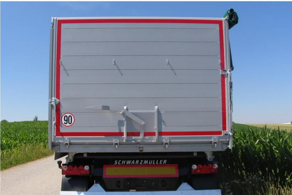
Aluminium-Hohlprofil-Rückwand, abklappbar und zusätzlich pendelbar mit man. Zentralverriegelung, sowie
