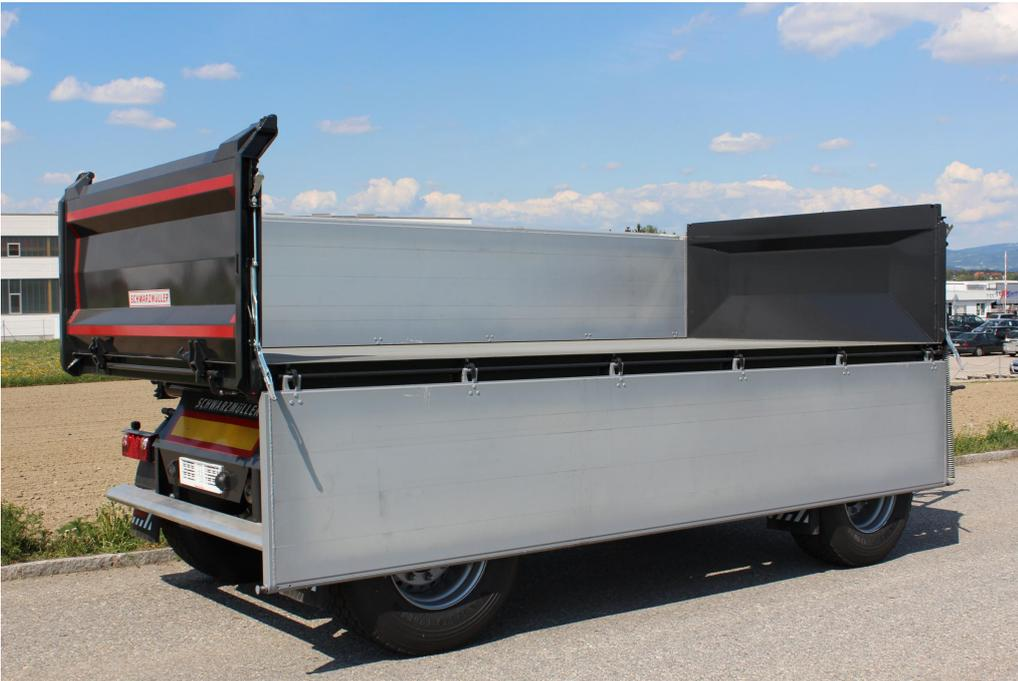
2-Achs-3-Seiten-Kipphanhänger mit abgeklappter Seitenwand
