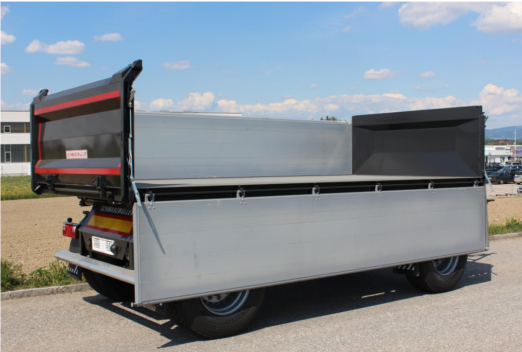
2-Achs-3-Seiten-Kippanhänger mit abgeklappter Seitenwand
