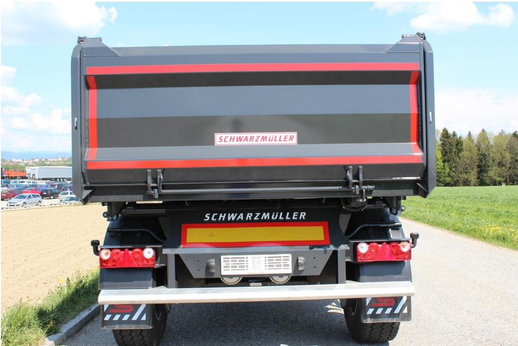
Stahlblech-Rückwand 4 mm, pendelbar mit erhöhter Lagerung und autom. Pneumatikverschluss
