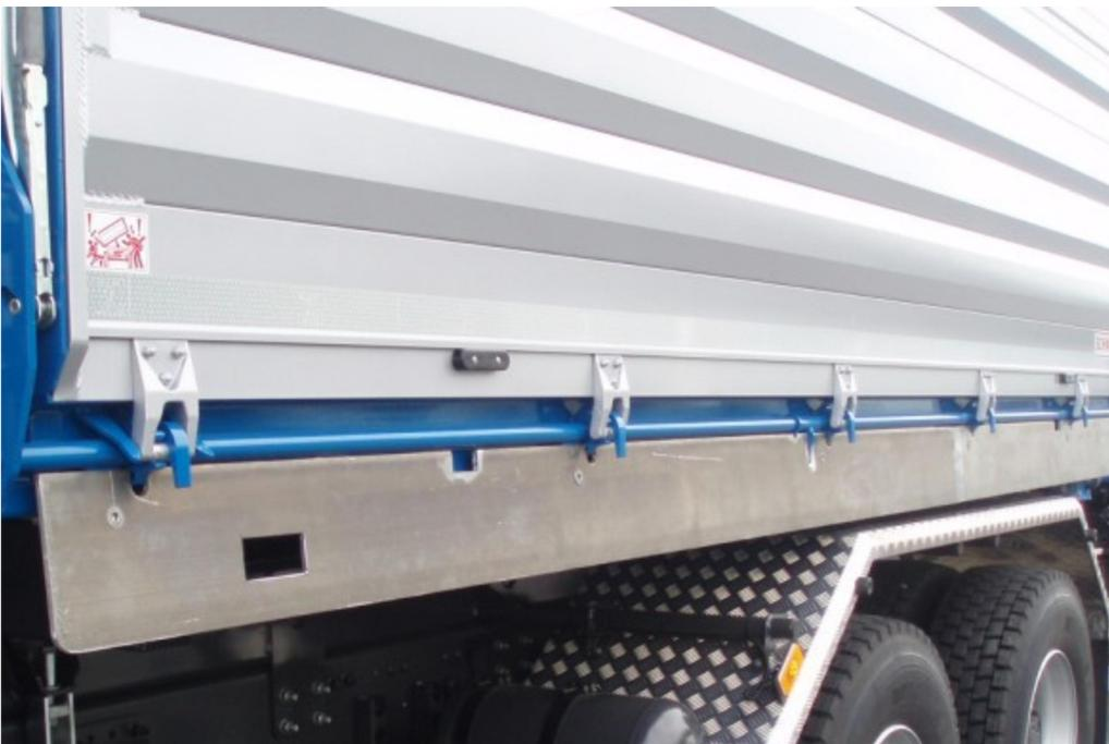
OPTIONAL: Aluminium-Klappe auf seitlicher Zentralverriegelungswelle
