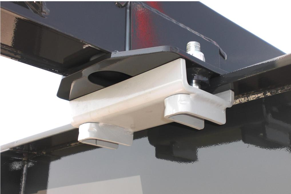
Rungenstücke mittels angeschweißter Klemmbefestigung aufgesetzt = versetzbar
