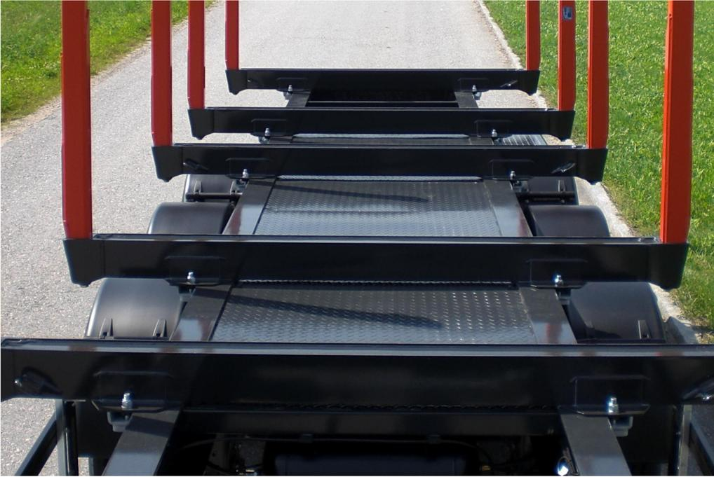
Stahl-Tränenblech-Abdeckung zwischen den Rahmenlängsträgern über dem Fahrwerk und vorne
