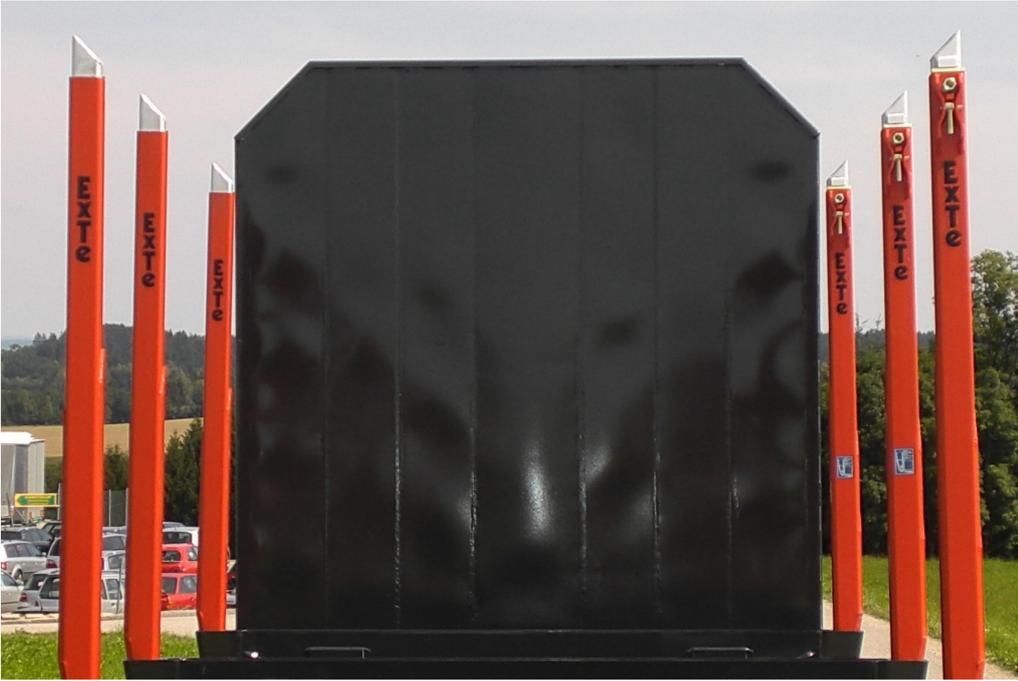
OPTIONAL: Extrastarke Stahlprofil-Vorderwand, ca. 2.500 mm hoch mit Mittelstützen
