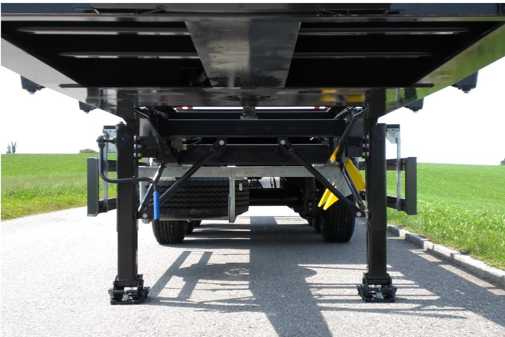
Leichtbaurahmen aus hochfesten NAXTRA-Spezialstählen und dadurch ein Nutzlastvorteil von bis zu 500 kg
