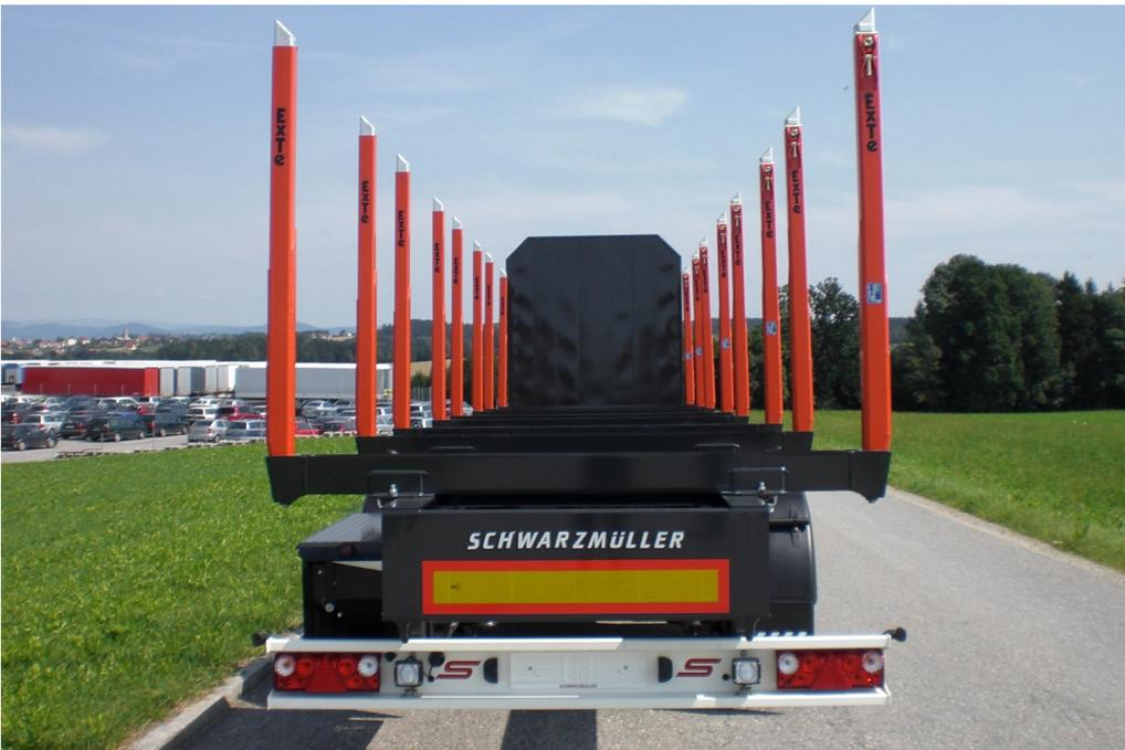
Heckabschluss inkl. montiertem Aluminium-Unterfahrsatz
