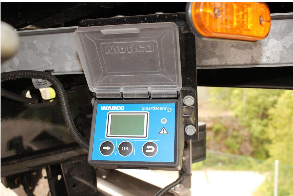
OPTIONAL: SmartBoard zum Auslesen der Daten über Display am Fahrzeug (Kilometerstand, Achsaggelast, Bremsdiagnose etc.)
