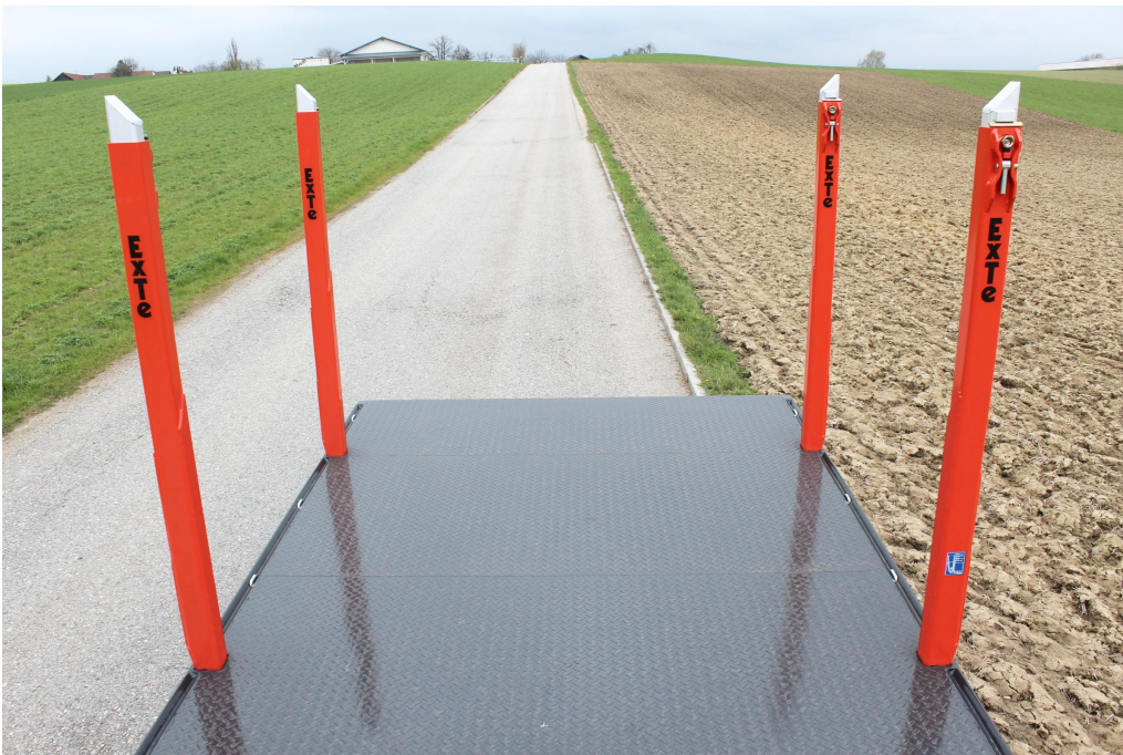
Stahltränenblechboden 5/7 mm, heftgeschweißt
