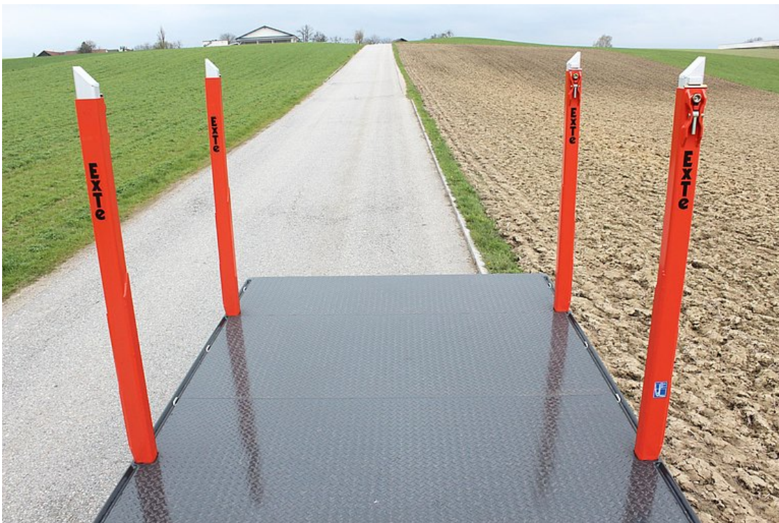
Exte-Rungentaschen mit Verstärkungsträger samt 2-teiligen Exte-Rungen 144-S mit Schraubenbefestigung (Belastbarkeit 7 t/Pair)
