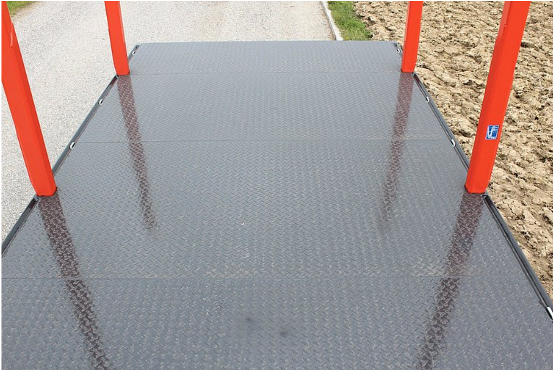
Stahltränenblechboden 5/7 mm, heftgeschweißt
