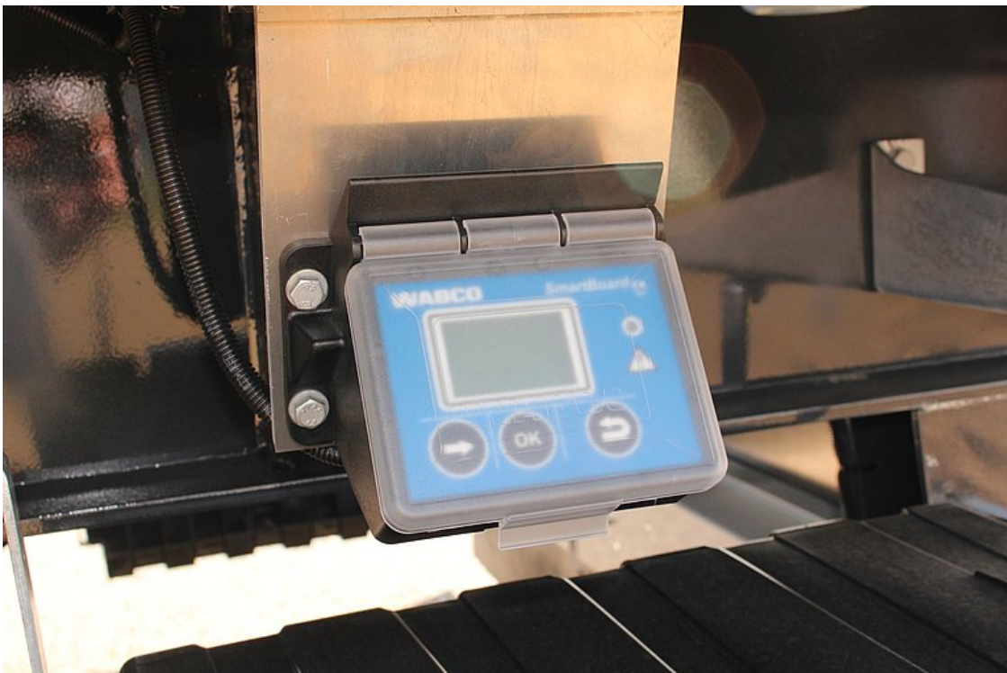
OPTIONAL: SmartBoard zum Auslesen der Daten über Display am Fahrzeug (Kilometerstand, Achsaggregatlast, Bremsdiagnose etc.)
