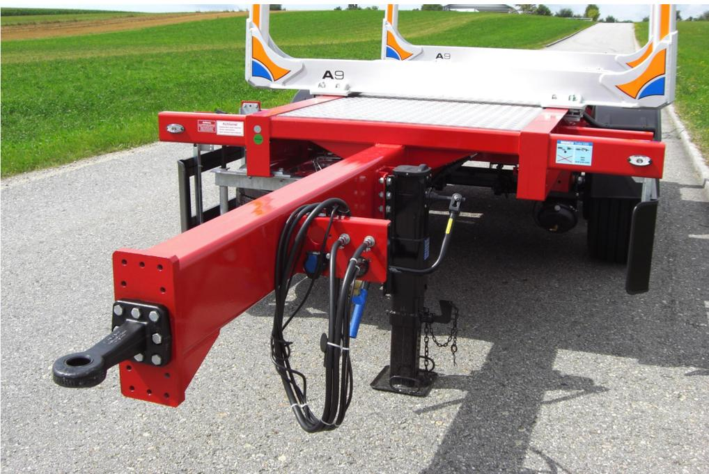
Höhenverstellbare Zugstange für Zentralachs-Schwerlastkupplung
