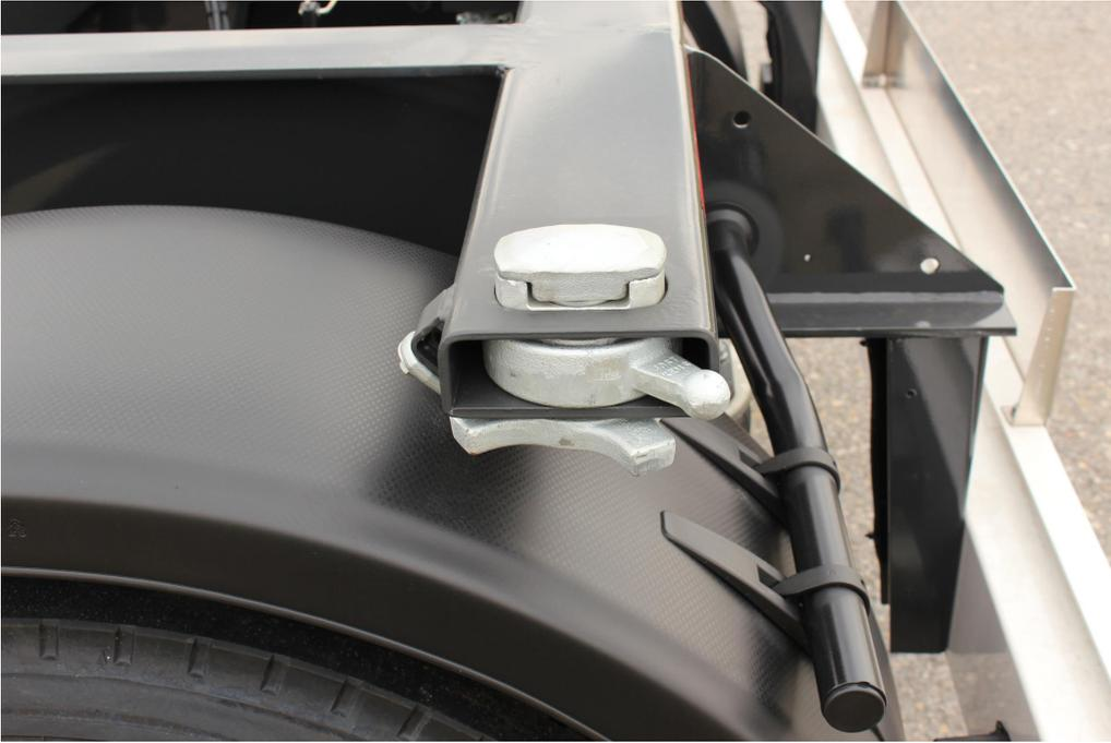
Auflageträger samt 4 Containerverschlüsse nach EN 284 (20ft-Verriegelungsmaß)
