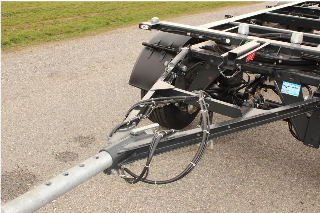
Ausziehbare Zuggabel, max. 600 mm verstellbar, mit Getofix-Deichselstütze
