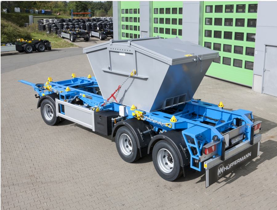
Vario Carrier zum Transport von einem Absetzbehälter im Nutzlastschwerpunkt
