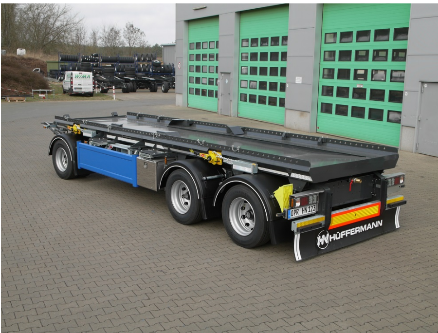
Vario Carrier zum Transport von einem Absetzbehälter im Nutzlastschwerpunkt
