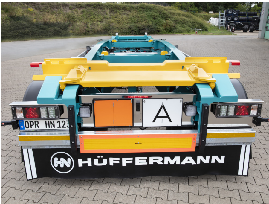
Hella-Modulbeleuchtungseinrichtung mit Funktionsleuchten in Teil-LED-Technik
