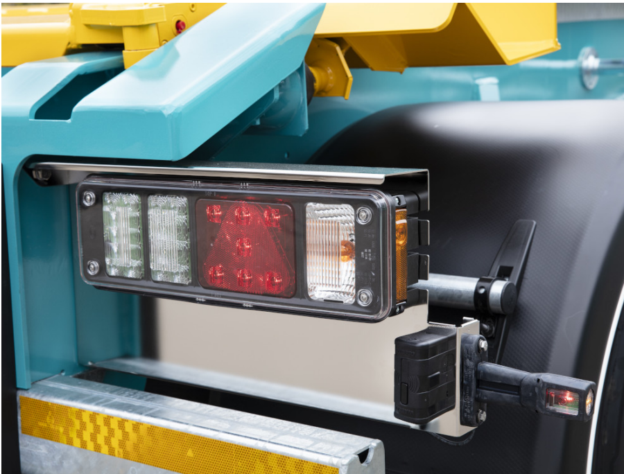
Hella-Modulbeleuchtungseinrichtung mit Funktionsleuchten in Teil-LED-Technik
