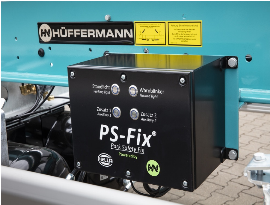
OPTIONAL: Autarkes Beleuchtungssystem für mehr Sicherheit
