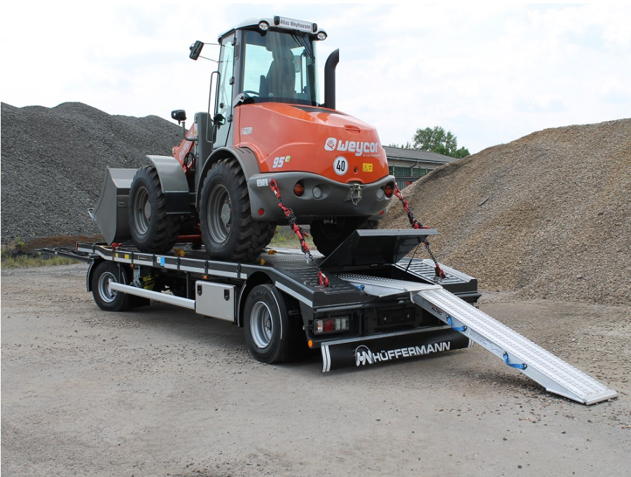
Versenkte und variabel umschaubare Zurrpunkte im Außenrahmen
