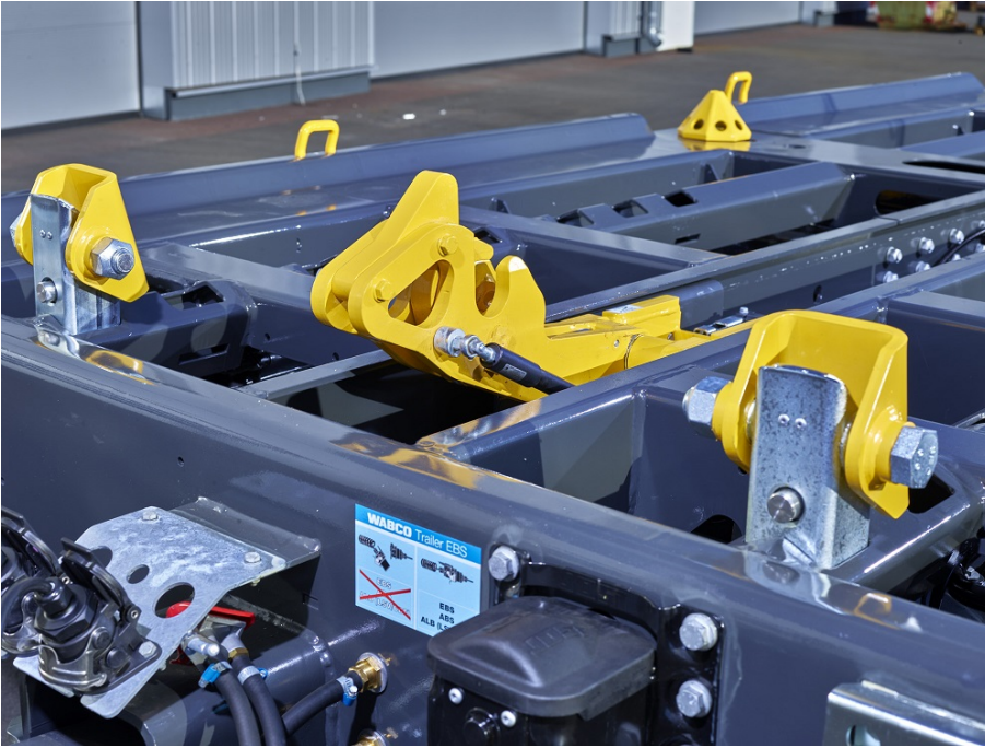
OPTIONAL: Kettenlose Ladungssicherung - verstellbarer Multi-Fix
