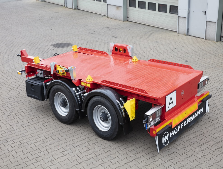
Sonderausstattung geschlossener Ladeboden aus Stahlblech und Safety-Fix
