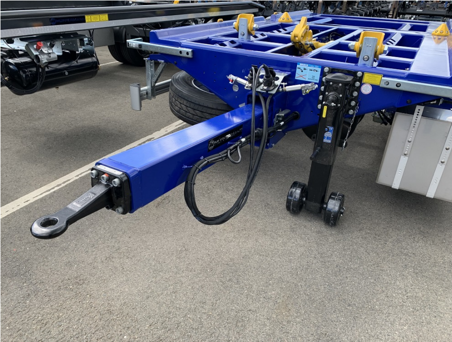
Frontansicht mit Stützwinde, höhenstellbarem Zugrohr und schraubbarer Zugöse
