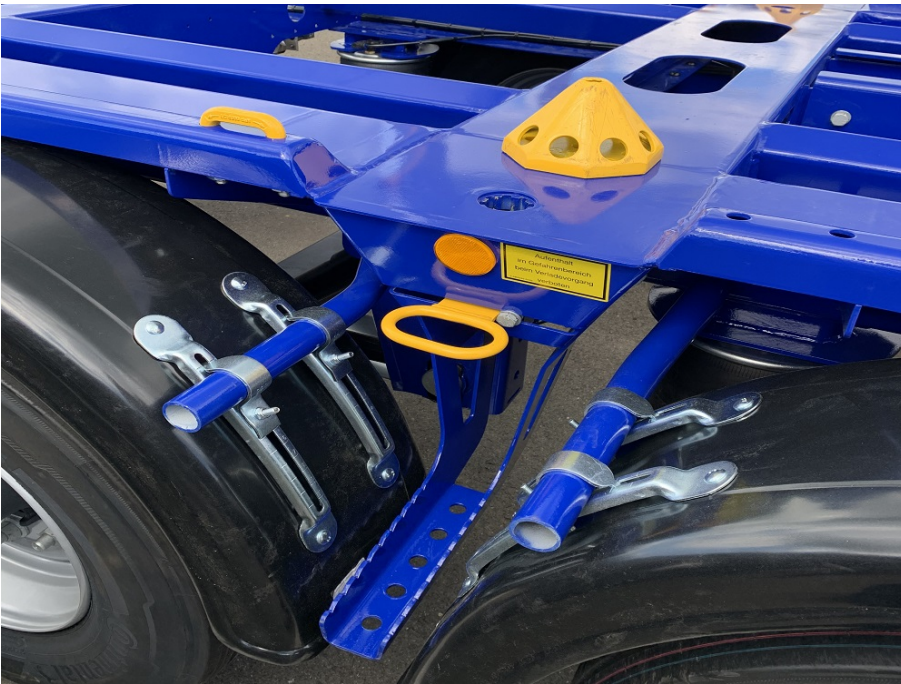
Zentrier-Fix umsteckbar auf verschiedene Behältergrößen
