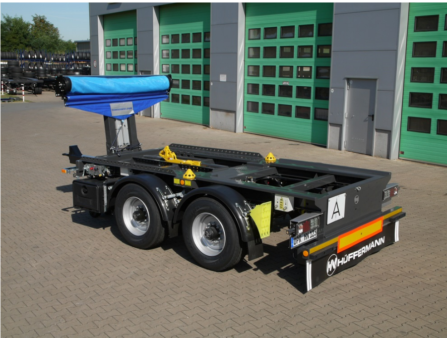
Zentrier-Fix umsteckbar auf verschiedene Behältergrößen
