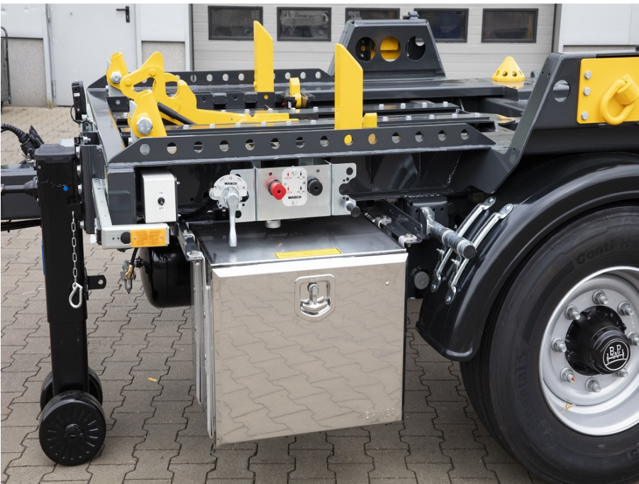
OPTIONAL: Kettenlose Ladungssicherung - verstellbarer Multi-Fix
