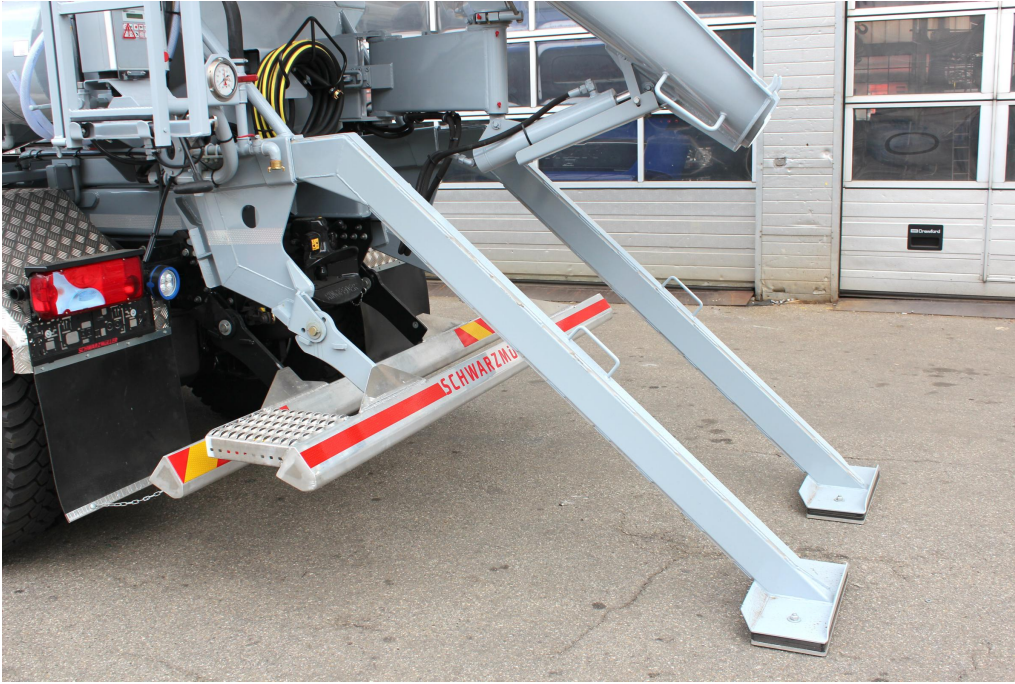
Schräg nach hinten verlaufenden Abstützungen zum sicheren Abstellen des Aufbaus
