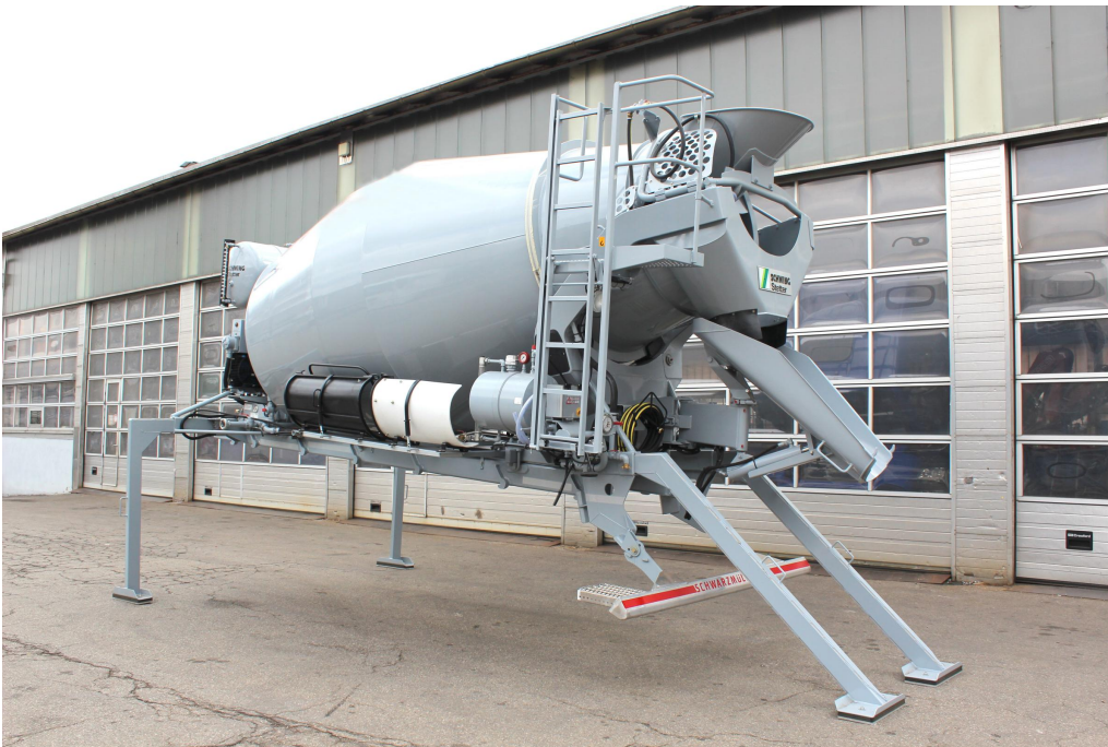
Schräg nach hinten verlaufenden Abstützungen zum sicheren Abstellen des Aufbaus
