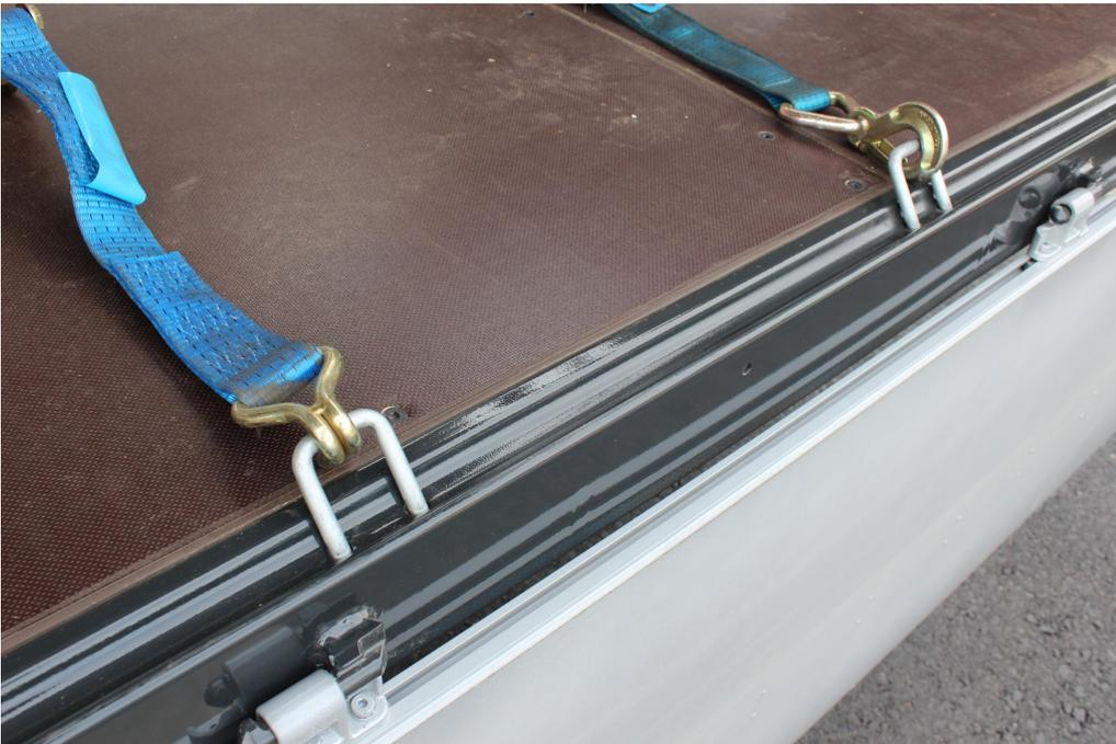
Zurrbügel-Außenrahmen mit versenkten 2,5 t Zurrbügel
