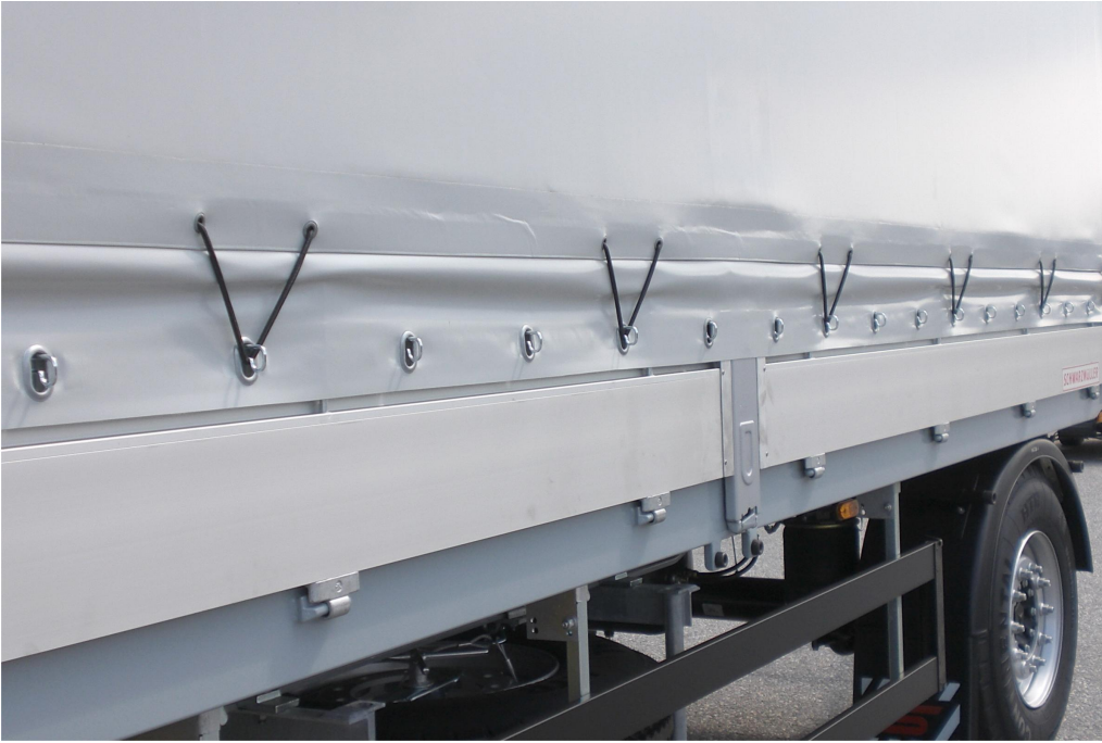
OPTIONAL: Ausführung in Schiebeplane + Bordwände
