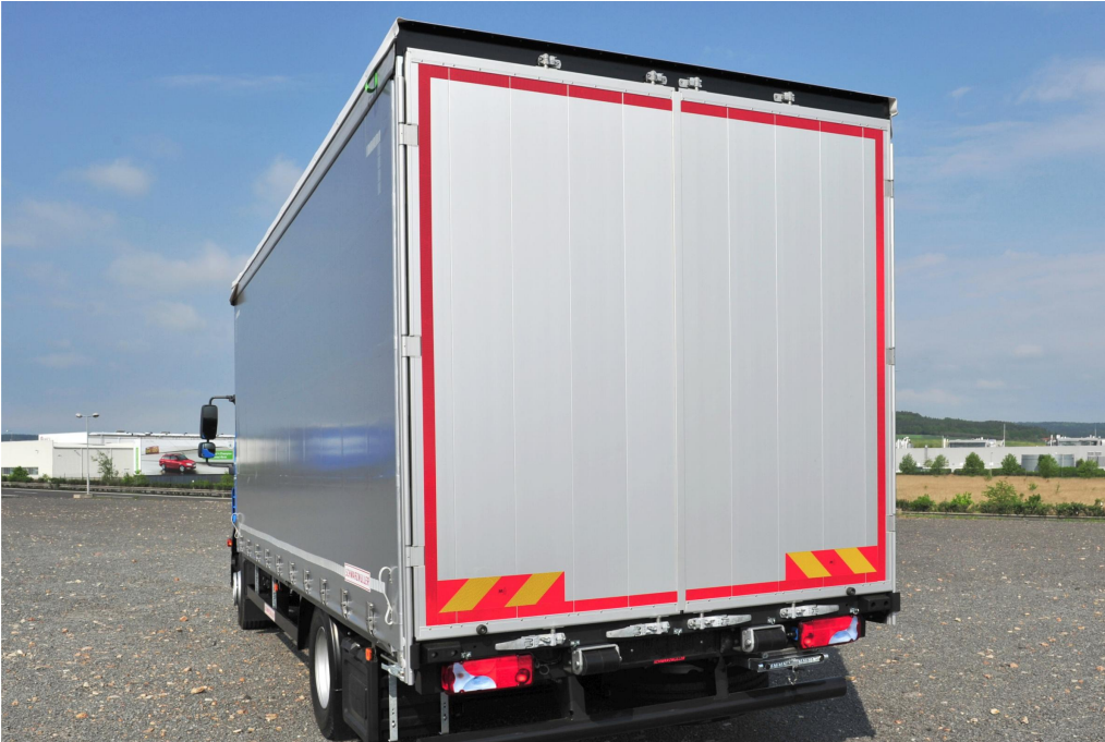
Hinten angeschraubtes Portal mit Aluminium-Ecksäulen, samt vollumschlagbarer Doppeltüre in Profilbauweise
