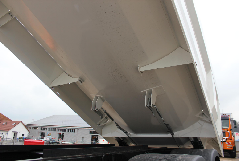
Bestmöglicher Stoß- und Verschleißschutz durch speziell gekantete Mulde
