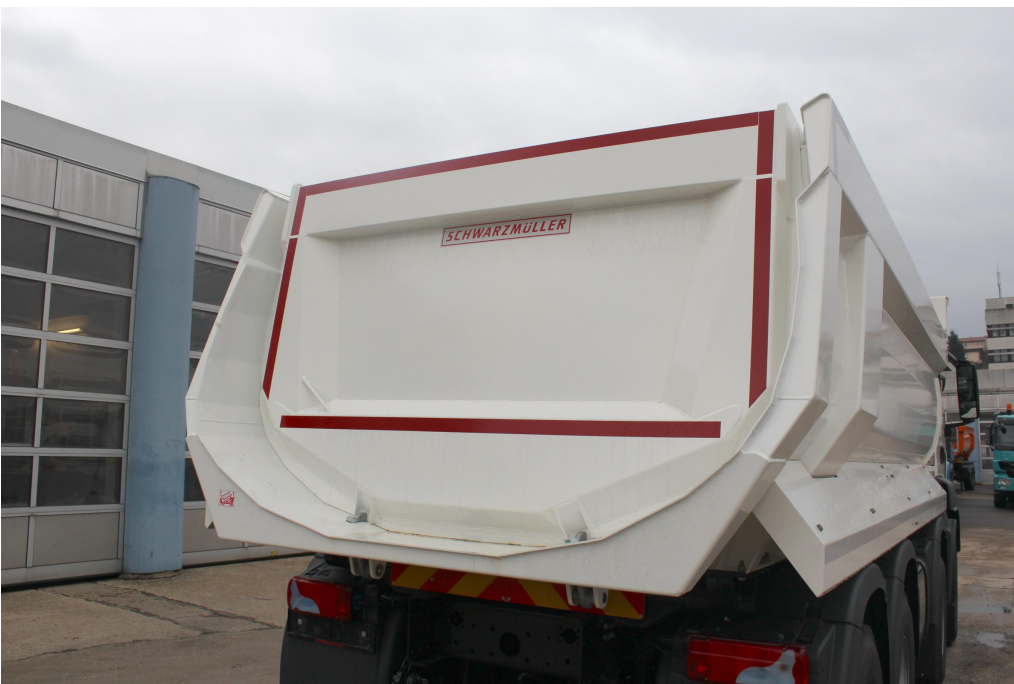
Vorderwand oben mit erhöhtem Baggerschutz
