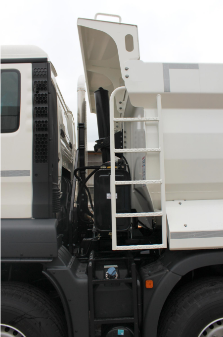
Bestmöglicher Stoß- und Verschleißschutz durch speziell gekantete Mulde
