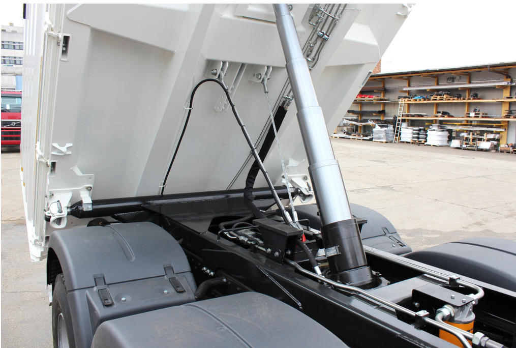
3-Seiten-Kippaufbau auf 4-Achs-LKW - Baustelle
