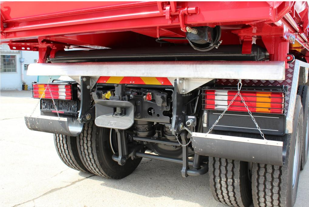
OPTIONAL: Aluminium-Unterfahrschutz hochklappbar für Fertigerinsatz
