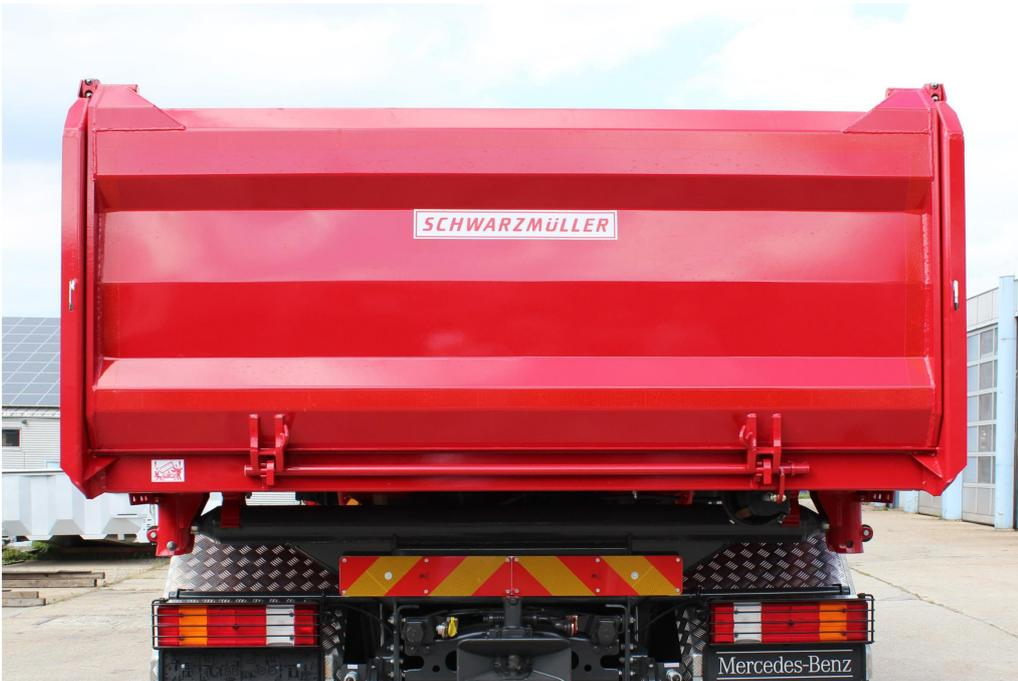
Stahlblech-Rückwand 4 mm, ca. 980 mm hoch, pendelbar mit erhöhter Lagerung und pneum. Verriegelung vom Fahrerhaus zu öffnen sowie zus. bedingt abklappbar
