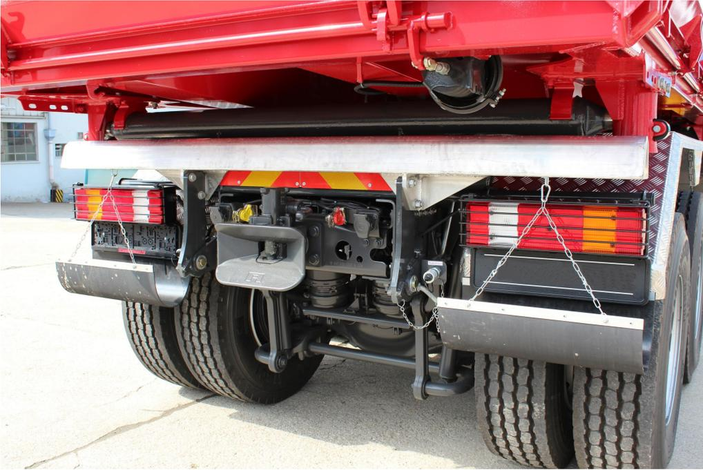
OPTIONAL: Aluminium-Unterfahrschutz hochklappbar für Fertigerinsatz
