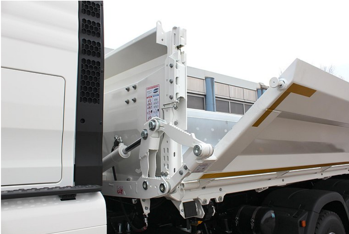
OPTIONAL: Linkseitig Bordmatic = hydraulisch abklappbare Seitenbordwand
