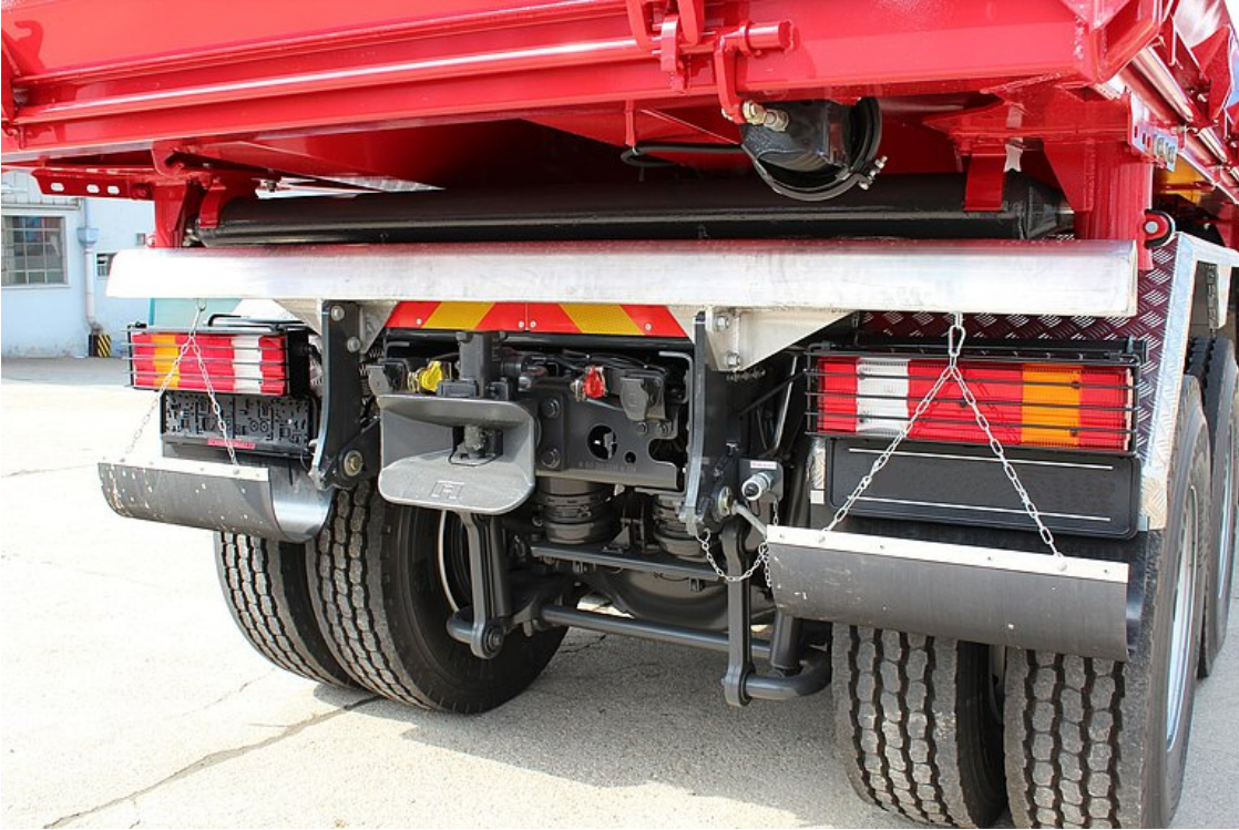
OPTIONAL: Aluminium-Unterfahrschutz hochklappbar für Fertigeresatz
