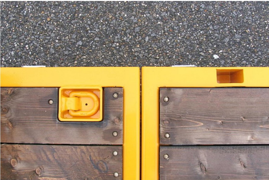
Versenkte hochklappbare Bodenzurringe im Tiefbett, sowie Zurrbügel am Außenrahmen
