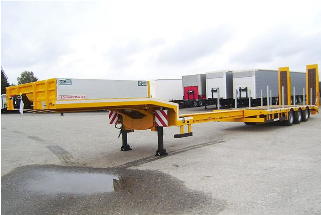
3-Achs-Tiefplanesattelanhänger - verstärkt - ausziehbar
