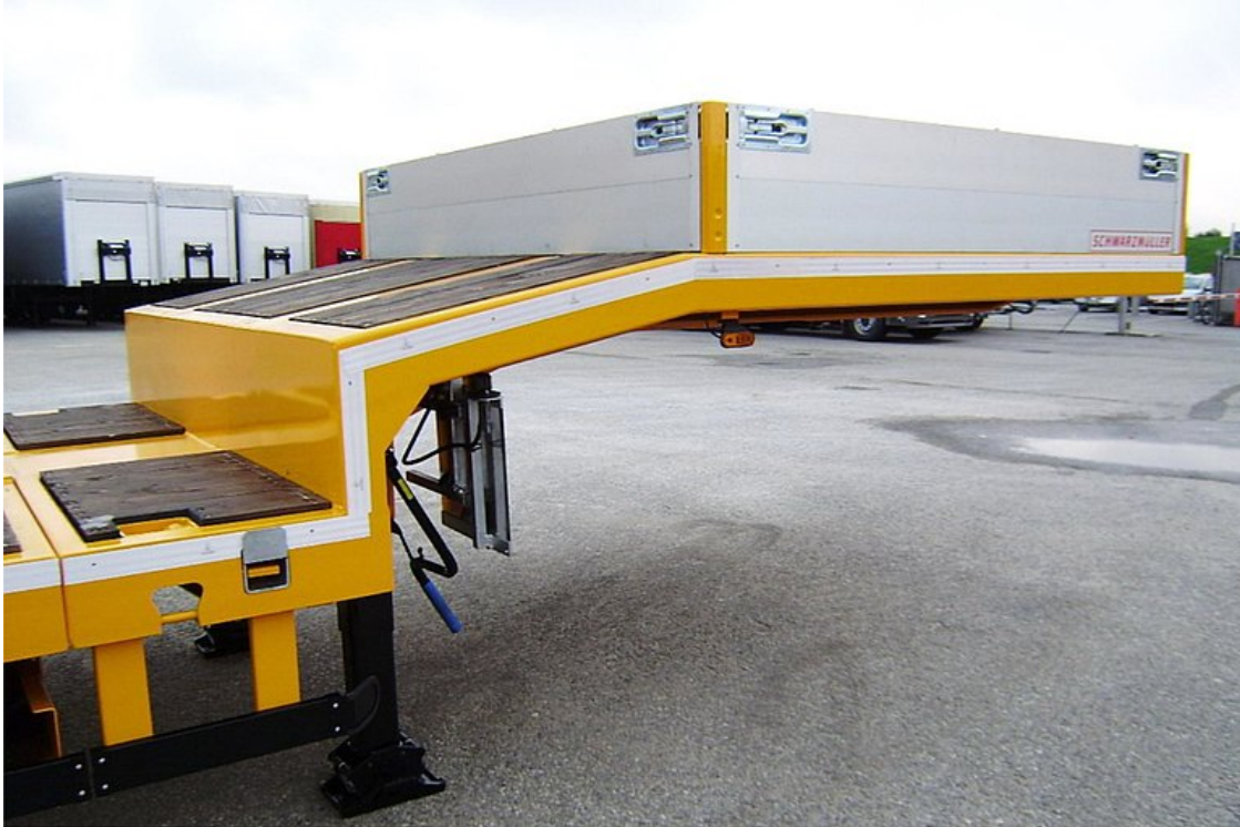
Vorne erhöhtes Kröpfungspaneeau inkl. steekbare Bordwände
