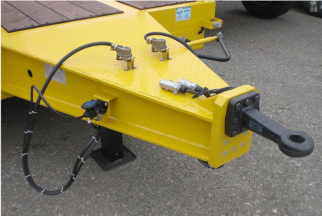
Zugvorrichtung vor dem Brückendeck zusammengezogen, mit geschraubter Zugöse
