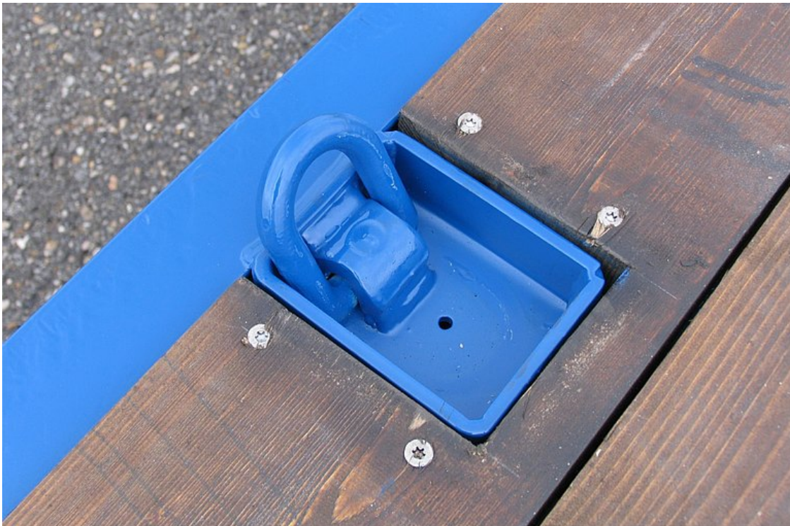
Im Boden versenkte Zurringe sowie Zurrbügel am Außenrahmen für optimierte Ladungssicherung
