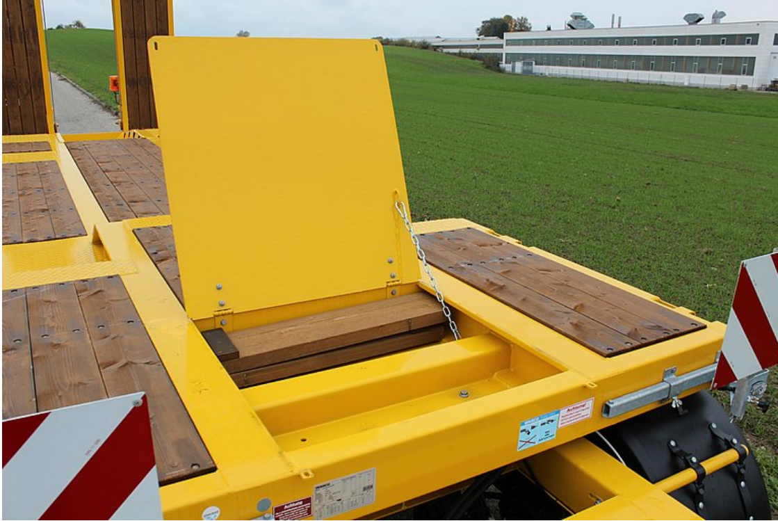
1 Zubehörfach vorne mittig im erhöhten Plateau, mit Klappdeckel
