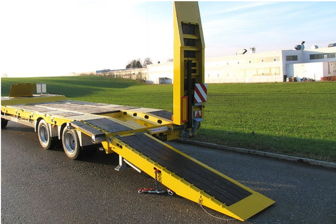
2 Klappbare 1-teilige Auffahrampen mit Hartholzbelag
