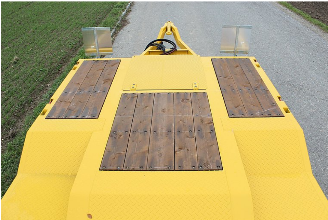
Vorne erhöhtes Plateau inkl. Rahmenkröpfung, Ecken abgeschrägt
