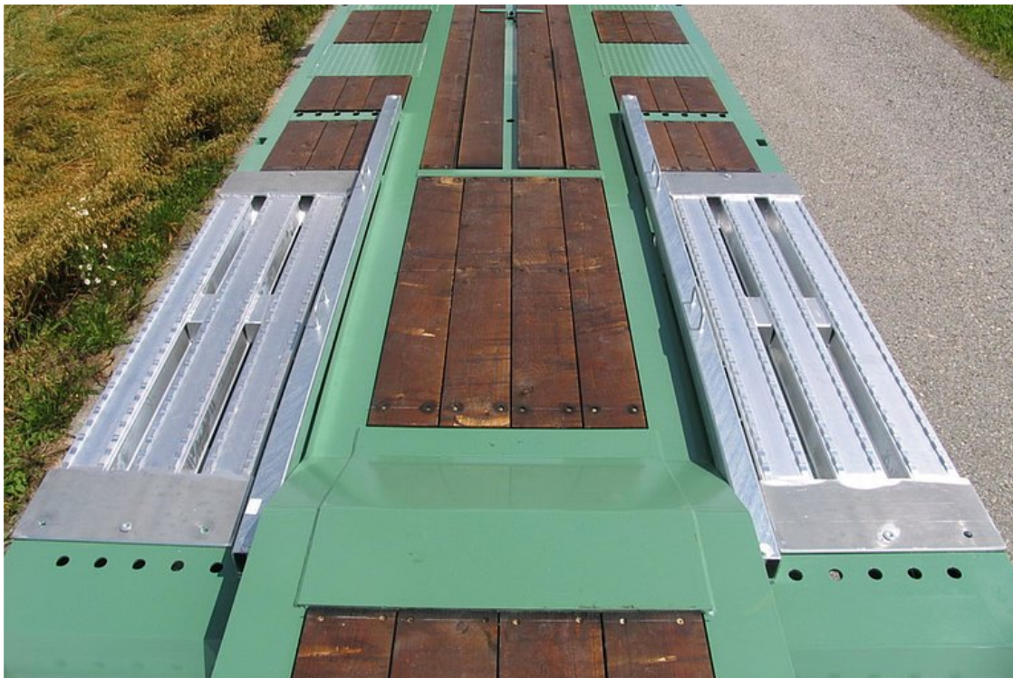
Radmulden mit überfahrbarer Aluminium-Abdeckung
