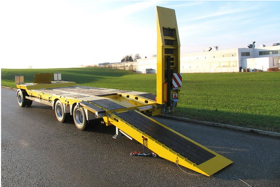
2 klappbare 1-teilige Auffahrampen mit Hartholzbelag
