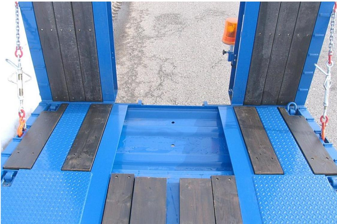
OPTIONAL: Baggerlöffelmulde - Vertiefung hinten zwischen den Längsträgern
