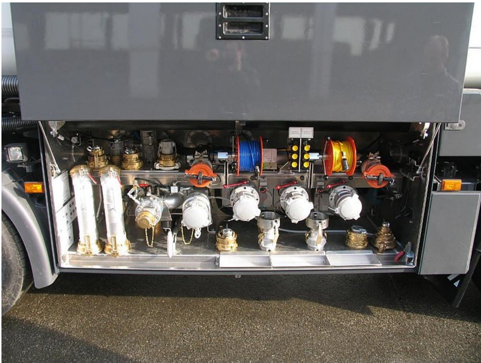
Armaturenschrank mit parallel geführten Schranktüren
