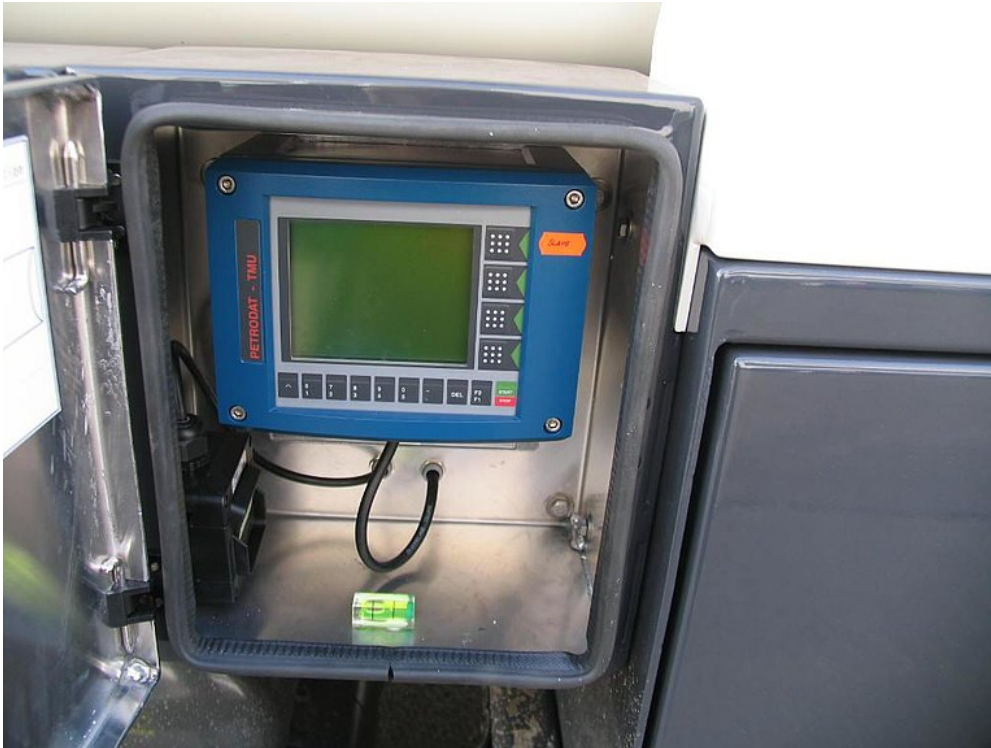
Links und rechts ein separater Aluminium-Kasten für die Bedienung des Peilstabes mit kleiner Wasserwaage
