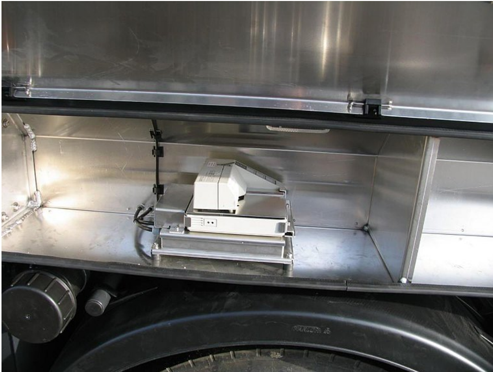
Aluminium-Kasten zum Schutz für den Drucker
