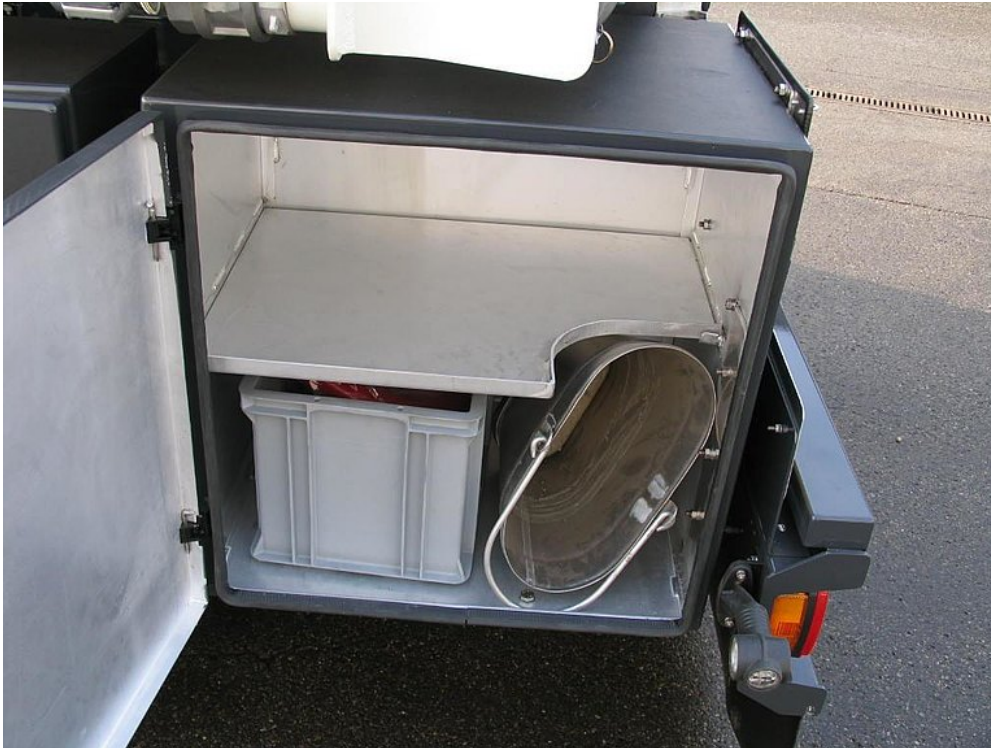
OPTIONAL: Zubehörkasten mit seitlich öffnender Tür bietet viel Stauraum
