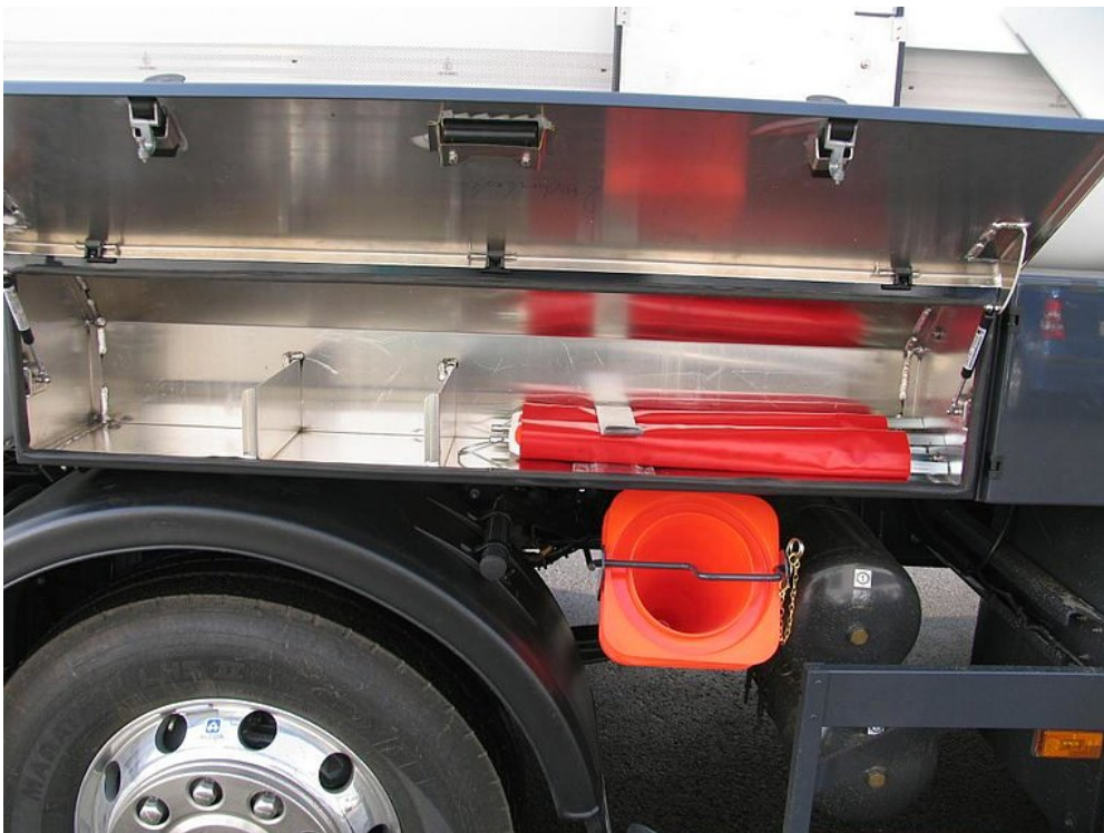
OPTIONAL: Sonder-Zubehörkasten mit seitlich öffnender Tür bietet noch mehr Stauraum
