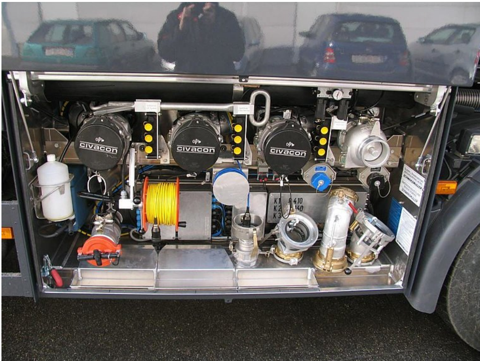
Übersichtliche und aufgeräumte Anordnung der Armaturen für effiziente und fehlerfreie Bedienung
