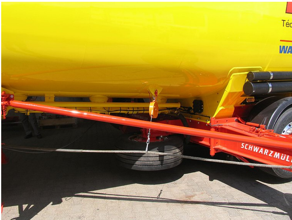
Knickschutzseile im Bereich der Auslegerabstützung zum Tank
