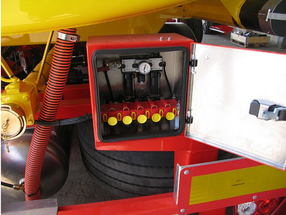
Kasten für pneum. Ventilsteuerung zum Schutz der Ventile
