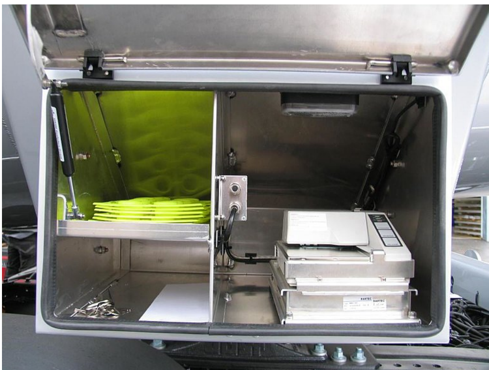
Separater Druckerkasten für perfekten Schutz gegen mechanische Beschädigung und Wettereinflüsse
