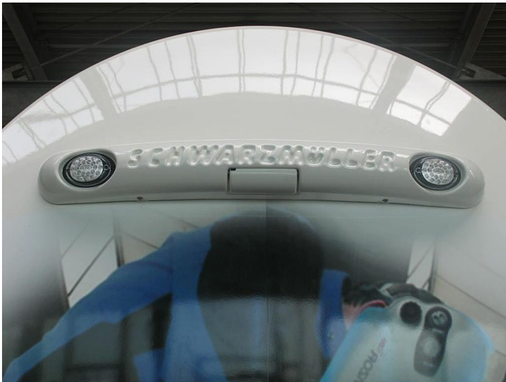
OPTIONAL: Hochgesetzter LED-Leuchtenträger mit Möglichkeit einer integrierten Rückfahrkamera
