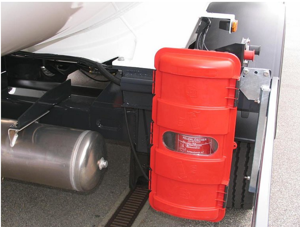
OPTIONAL: Feuerlöscherkasten mit Sichtfenster
