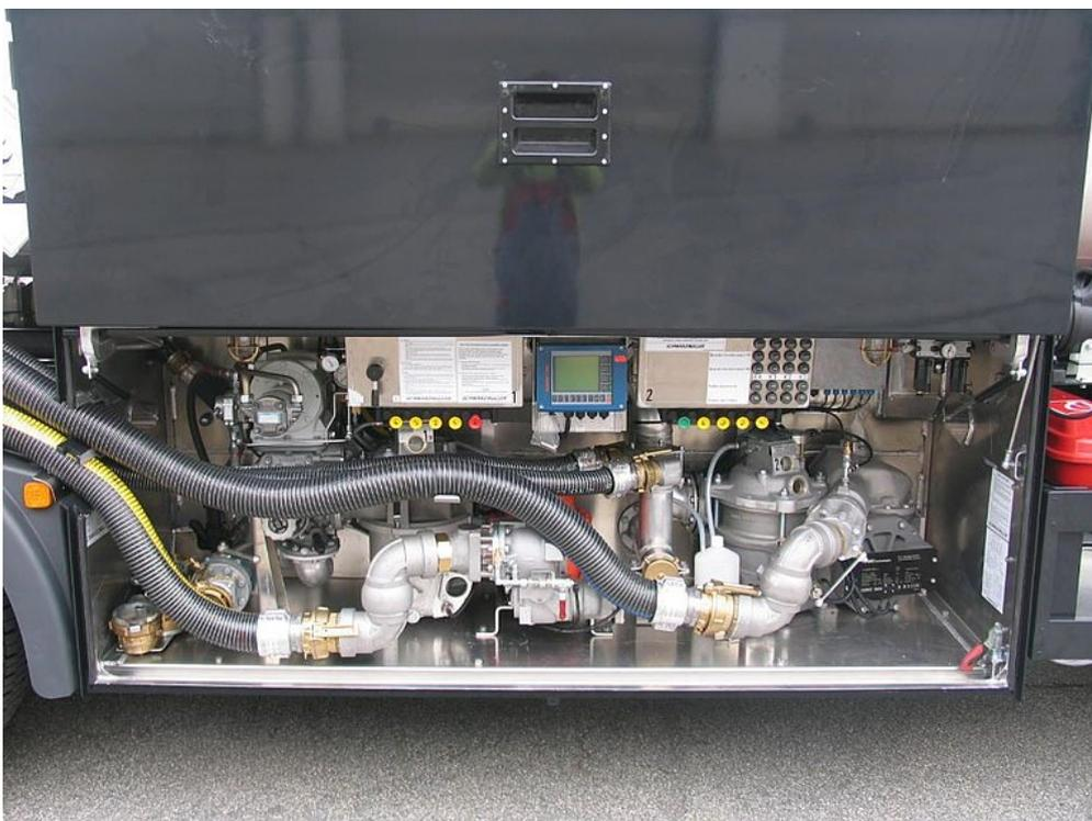
Armaturenschrank mit parallel geführter Schranktür
