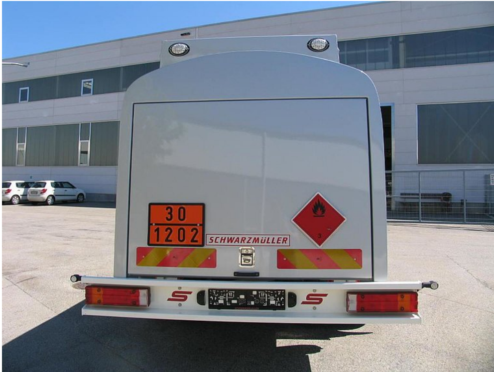
OPTIONAL: 2 hochgesetzte Rückleuchten im Heckschrank versenkt montiert
