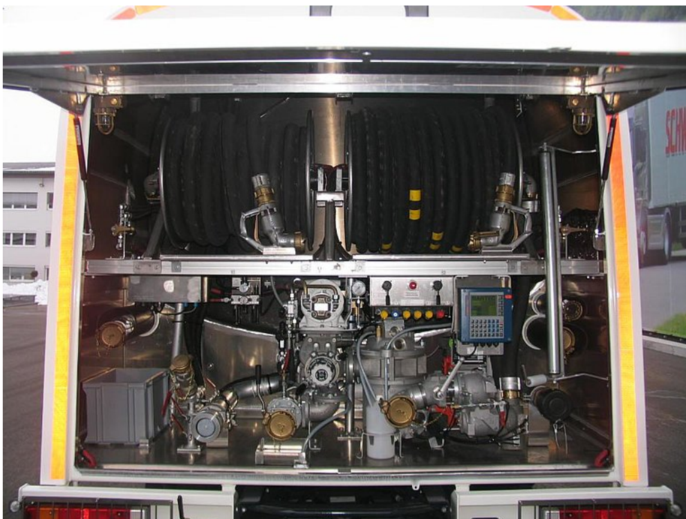
Heckschrank mit hochklappbarer Tür für Messanlage und Schlauchtrommel
