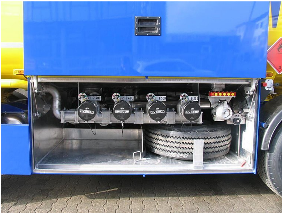
Armaturenschrank mit parallel geführten Schranktüren und Unterbringungsmöglichkeit für Reserverad
