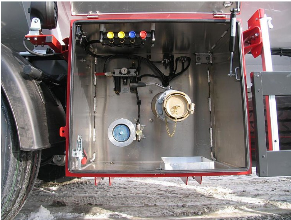
Auslaufkasten mit nach oben öffnender Tür zum Schutz der Armaturen
