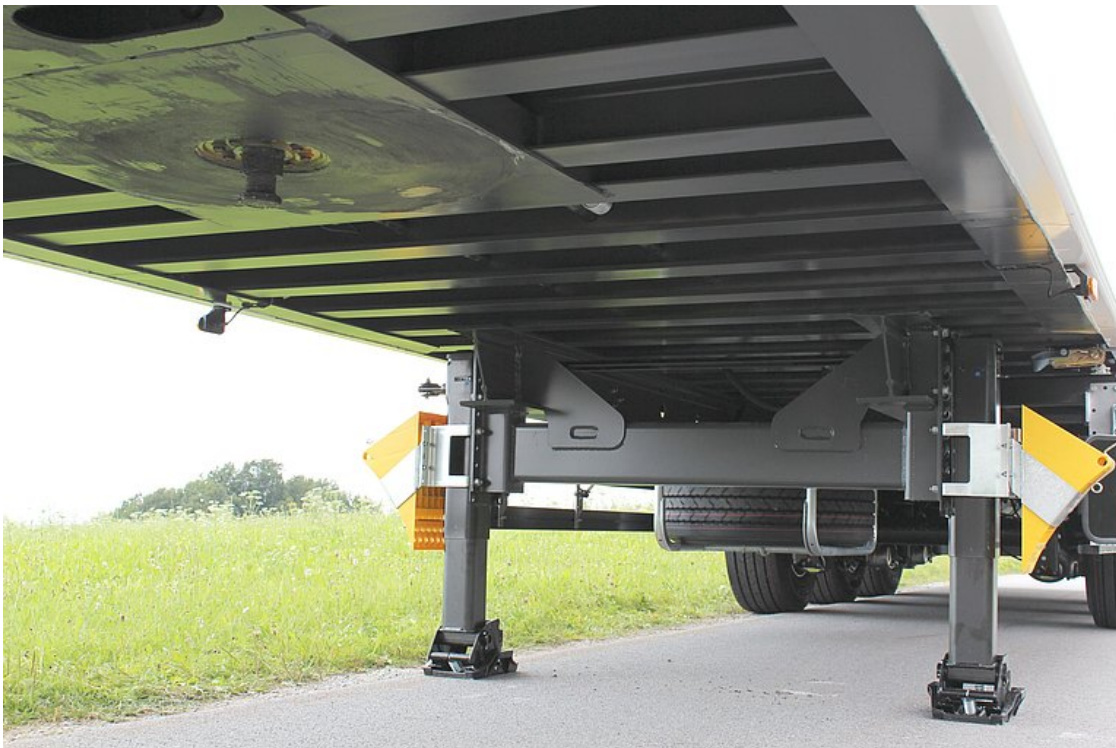
Aluminium-Leichtbaurahmen und dadurch ein Nutzlastvorteil von bis zu 500 kg
