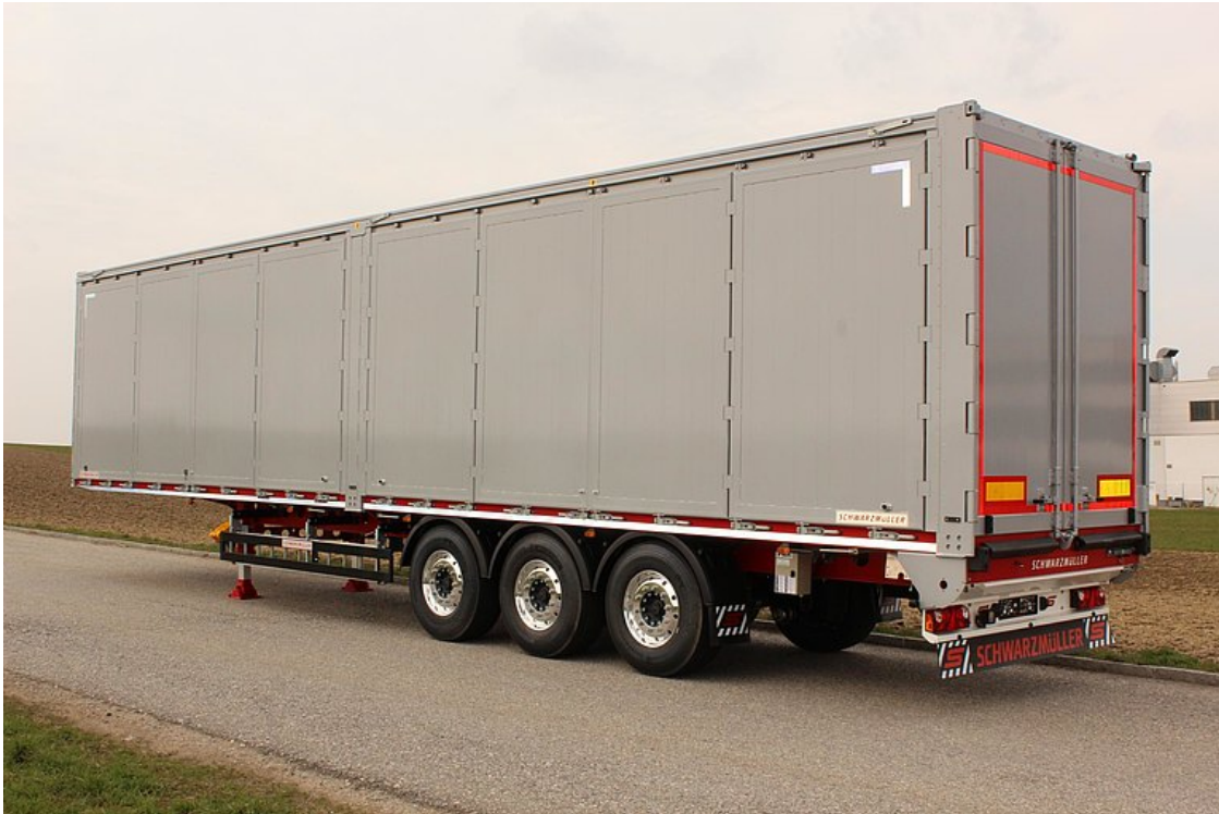
3-Achs-Schubboden-Sattelanhänger mit Seitentüren
