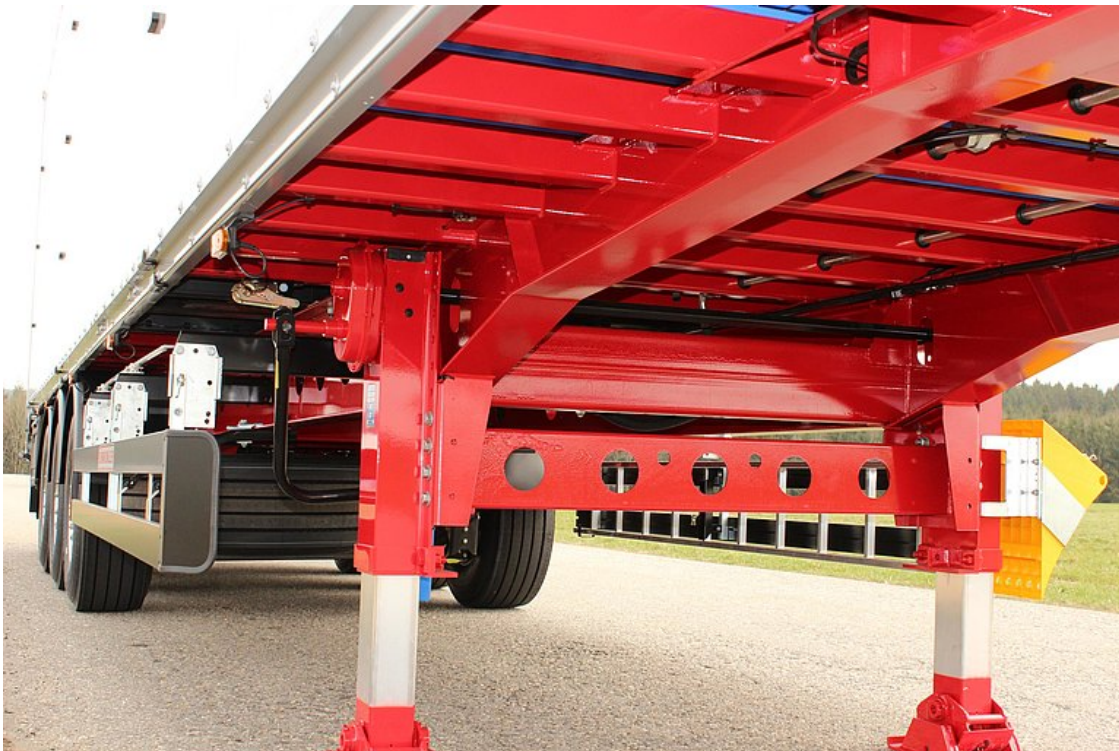
Verwindungssteife, durchgehende Stahl-Rahmenkonstruktion
