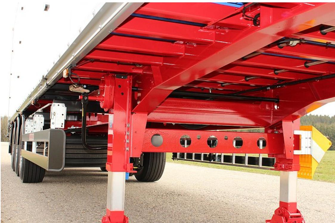
Verwindungssteife, durchgehende Stahl-Rahmenkonstruktion
