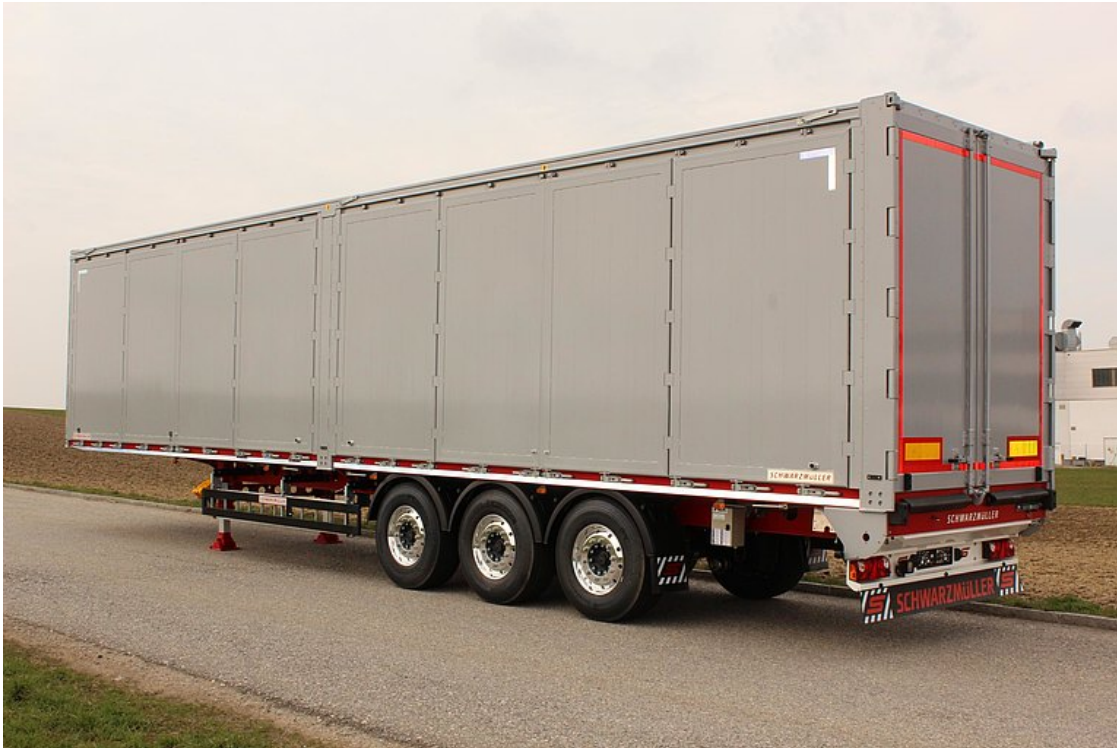
3-Achs-Schubboden-Sattelanhänger mit Seitentüren
