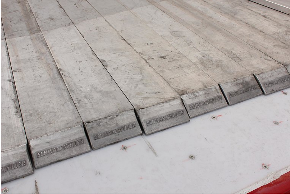
Cargoflor-Schubboden, hydraulisch verschiebbar mit 21-Bretter-System, für Be- und Entladung
